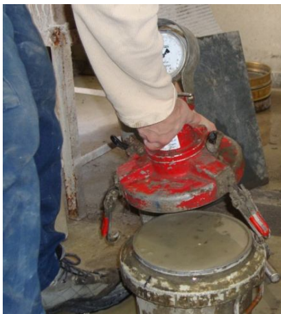
Slika 43: Zvibriran beton v posodi, namestitvev pokrova na posodo za določitev vsebnosti zraka v svežem betonu – površina je zglajena z robom posode.
