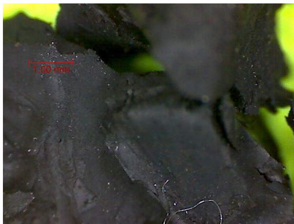
Slika 19: Prikaz mikroskopske povečave zrn granulirane gume.
