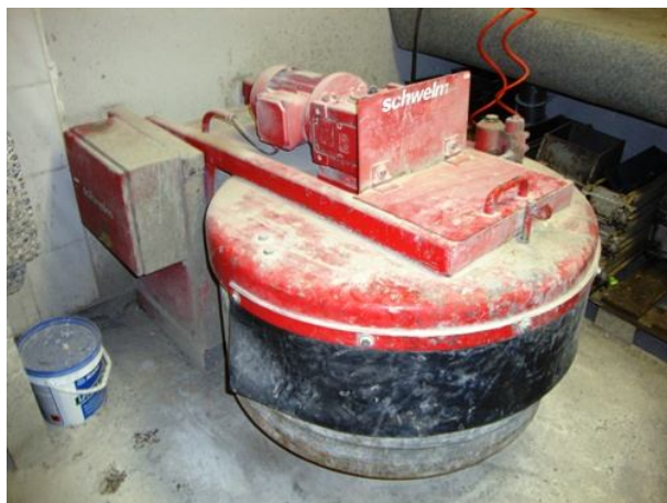
Slika 32: Laboratorijski mešalec s katerim se je mešalo betonske mešanice.
