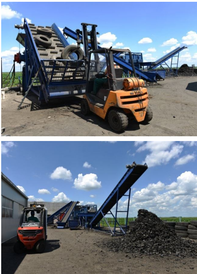
Slika 2: Nakladanje avtoplaščev za razrez z močnim trgalnim strojem, pri katerem ni potrebno predhodno odstraniti jeklenega obroča.
