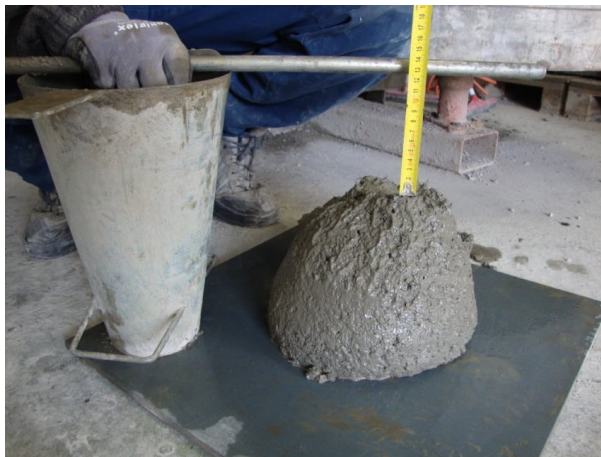
Slika 37: Izmerjeni posed svežega betona spada v razred S3 (mehko plastična konsistenca).
