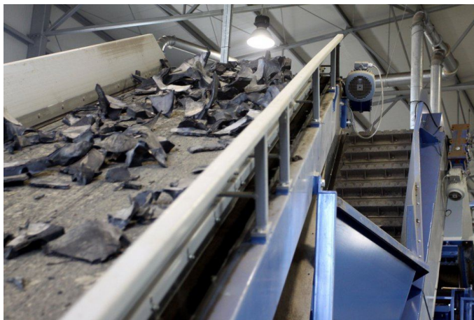
Slika 5: Transport že razrezanih avtoplaščev na večje kose.
