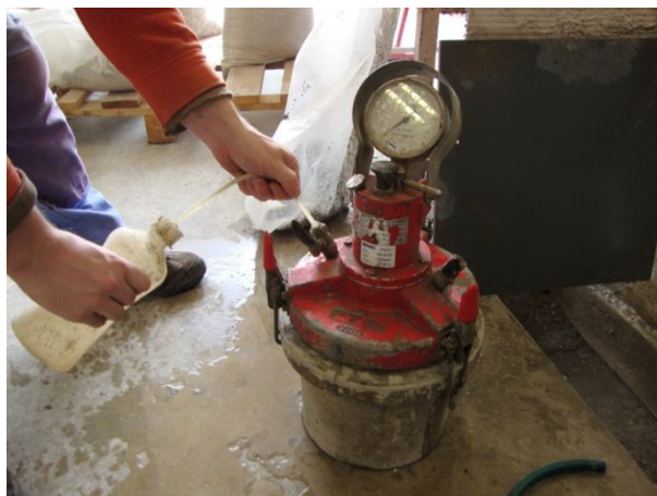
Slika 44: Prikaz vbrizganja vode z gumijasto brizgalko skozi ventil v posodo.
