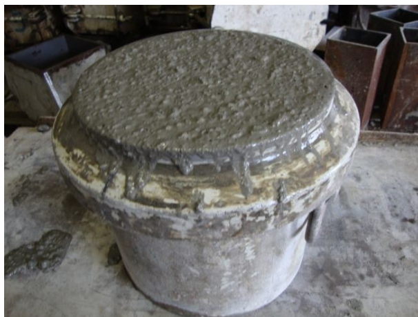
Slika 41: Zvibriran beton v posodi, pripravljen za določitev gostote svežega betona – površina je samo poravnana z robom posode.
