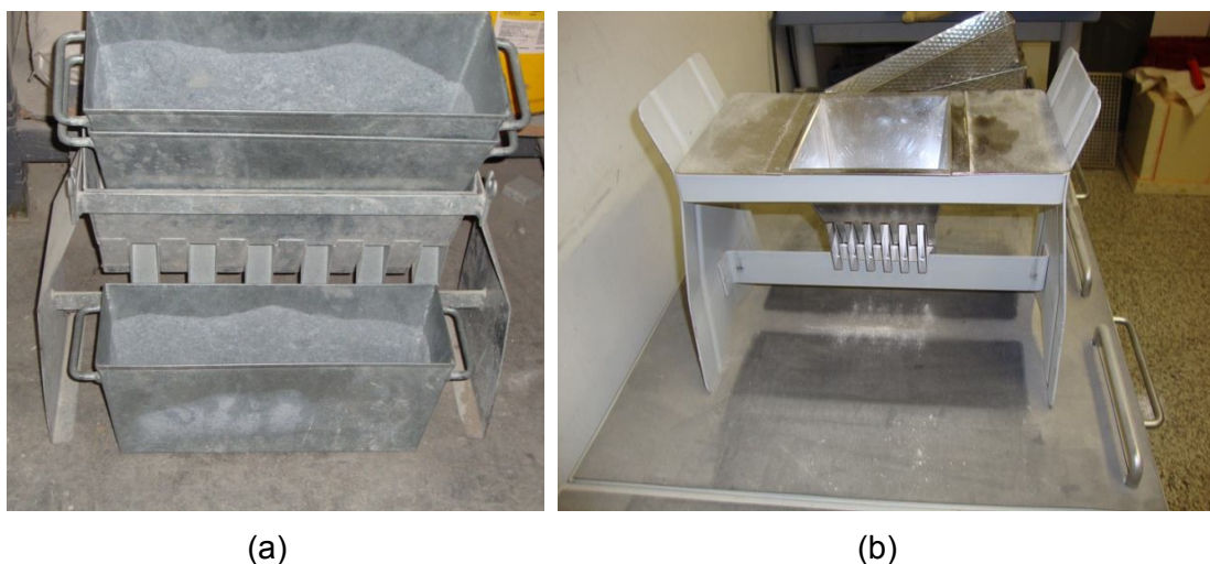
Slika 24: Razdelilna naprava ELO 108 (velika) (a) in ELO 224 (mala) (b).
