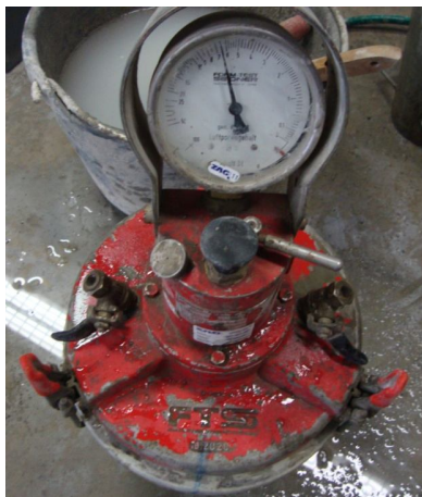
Slika 46: Kazalec na manometru pokaže delež por 6,5 %.
