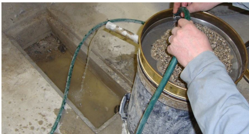
Slika 25: Prikaz pranja drobljenega agregata frakcije 0/4 mm.
