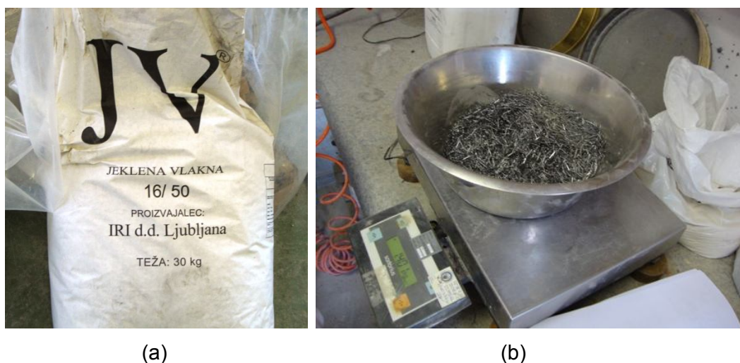
Slika 23: Vreča, v kateri so pakirana jeklana vlakna (a), in način doziranja v posodi za tehtanje (b).
