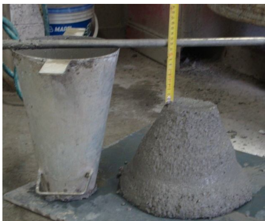
Slika 39: Prvi dan izmerjen razred poseda S3 (115 mm).
