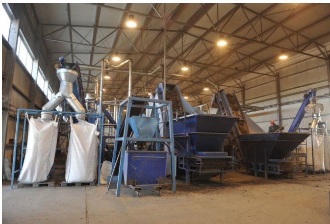
Slika 7: Mesto na katerem se vrši polnjenje tekstilnih vlaken in ločeno polnjenje jeklenih niti (delcev) v vreče.
