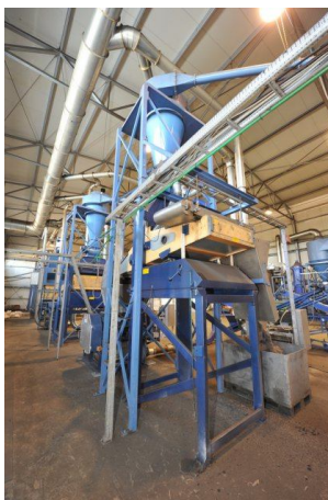
Slika 6: Odstranjevanje jeklenih delcev s pomočjo magnetov.
