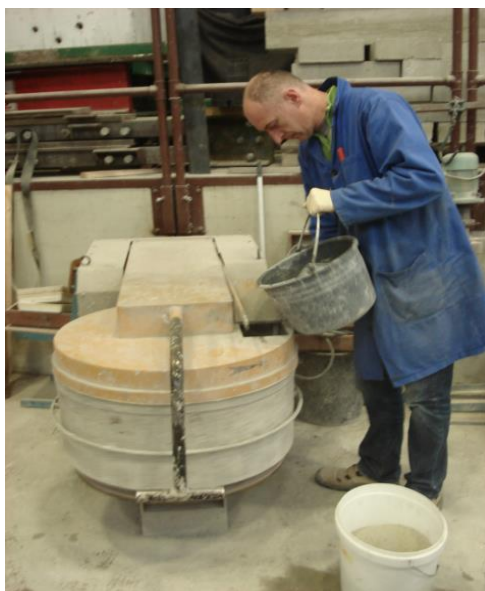
Slika 7: Velik protitočni mešalec v konstrukcijsko-prometnem laboratoriju na FGG kapacitete 50 l.
