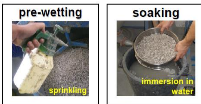
Slika 4: Dve vrsti namakanja lahkega agregata pred mešanjem. Postopek za oblikovanje mešanice SCLC, ki temelji na mokri packing metodi. [10]
