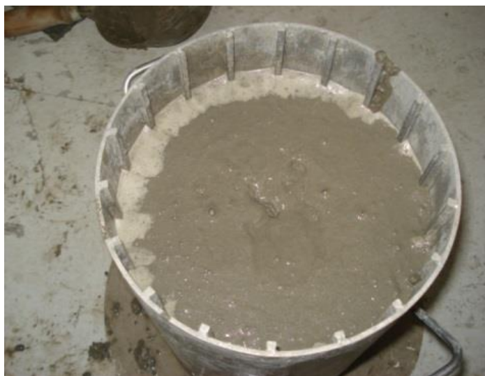
Slika 9: Pri mešanici W3 se je na površini penilo.
