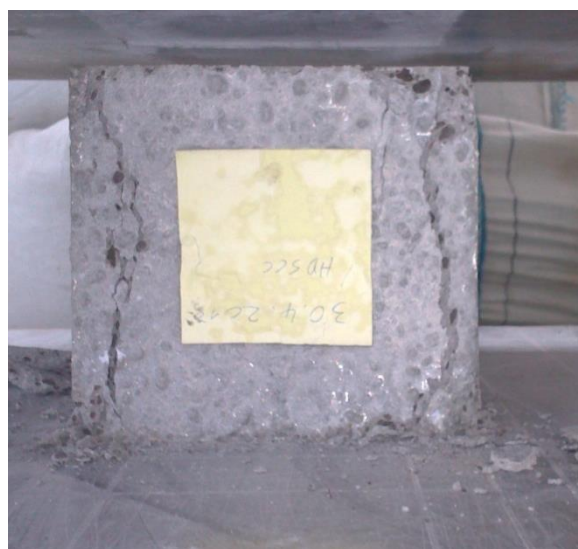
Slika 19: Primer zdrobljenega porušenega preizkušanca po tlačni obremenitvi.
