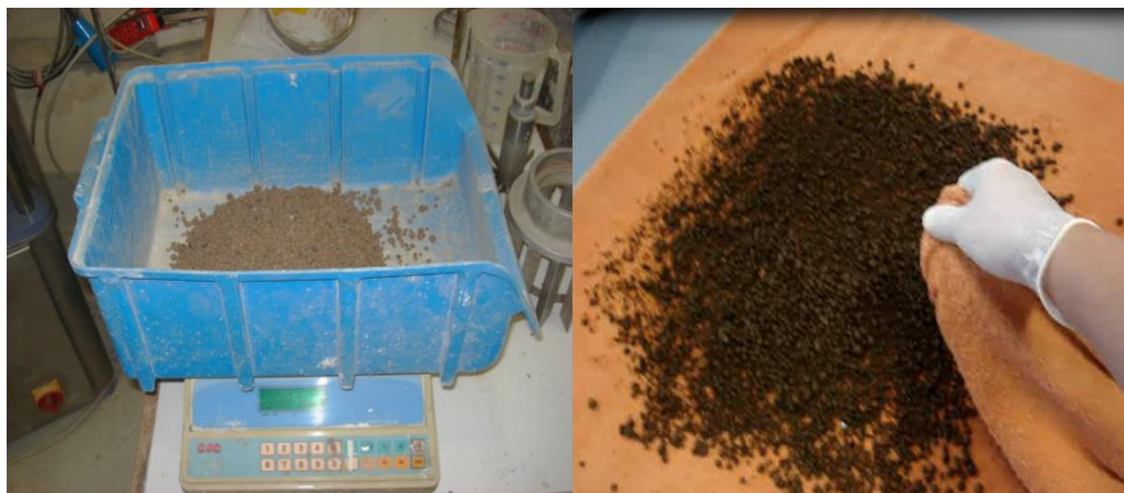
a) Tehtanje agregata
