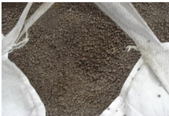
Slika 2: Uporabljeni material pri raziskavah - Liapor frakcija 1/8. [7]
