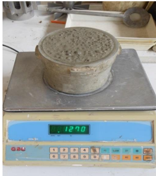
Slika 17: Določanje sveže prostorninske mase betona na tehtnici.
