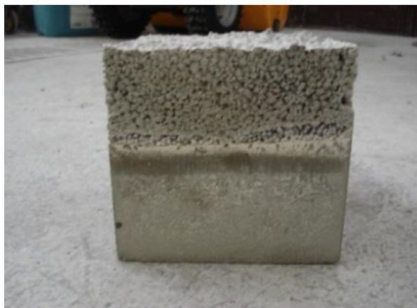
Slika 20: Primer segregacije lahkega agregata Liapor pri mešanici V2.
