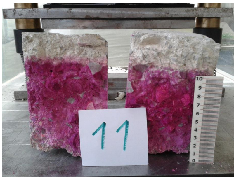
Slika 5: Preizkus globine karbonatizacije v betonu
