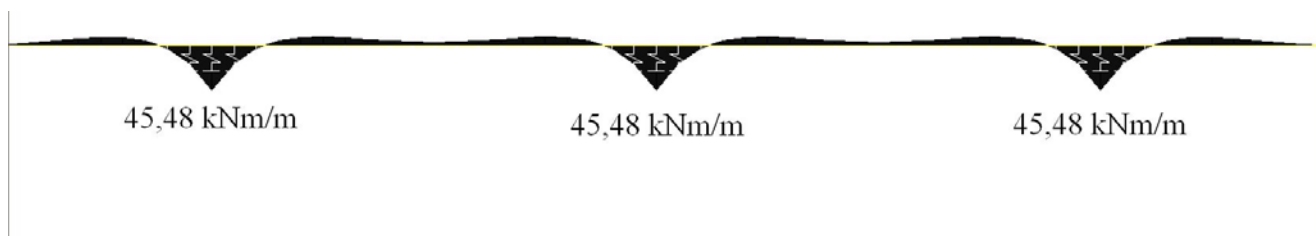
Slika 12 – upogibni moment v sidrni gredi
