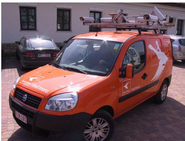
Slika 10: Vozilo z nameščenimi kamerami in skenerji
