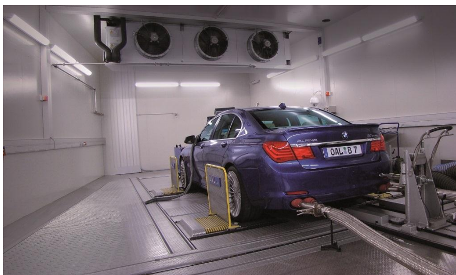
Slika 9: Osebno vozilo med testiranjem na šasijskem dinamometru (AVL, 2013)
