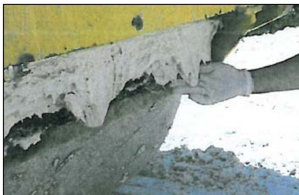
Slika 2.19: Pojav tiksotropije pri zgoščanju steklarske sadre (Petkovšek, 2008)
