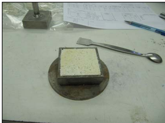
Slika 3.9: Vzorec steklarske sadre SR, pripravljen za vgradnjo v strižno celico
