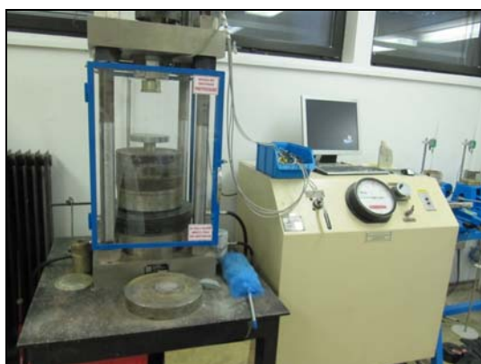
Slika 3.8: Stiskanje vzorca s stiskalnico in merjenje pomika
