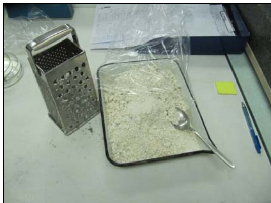
Slika 3.6: Priprava steklarske sadre SR za vgradnjo
