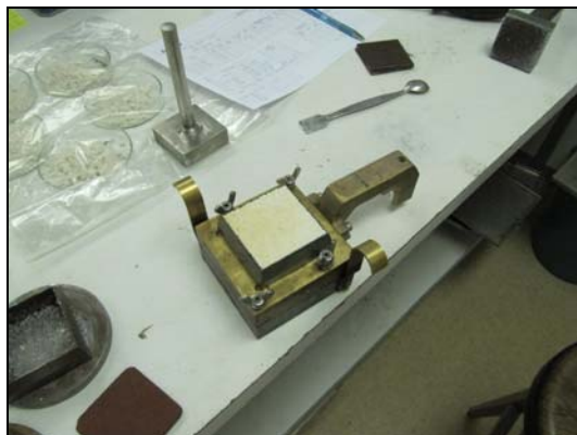
Slika 3.9: Vzorec steklarske sadre SR, pripravljen za vgradnjo v strižno celico
