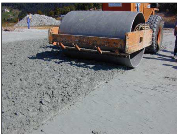
Slika 2.20: Postopno utekočinjenje materiala pri tehnoloških poskusih na terenu (Petkovšek, 2004)
