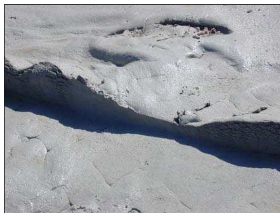
Slika 2.20: Postopno utekočinjenje materiala pri tehnoloških poskusih na terenu (Petkovšek, 2004)
