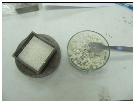
Slika 3.7: Razporeditev steklarske sadre SR v model in stiskanje po plasteh
