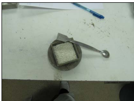
Slika 3.7: Razporeditev steklarske sadre SR v model in stiskanje po plasteh
