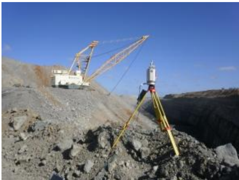
Slika 2: Merjenje nevarnega območja s skenerjem VZ-400 z varne razdalje (C.R.Kennedy & Co, 2013).
