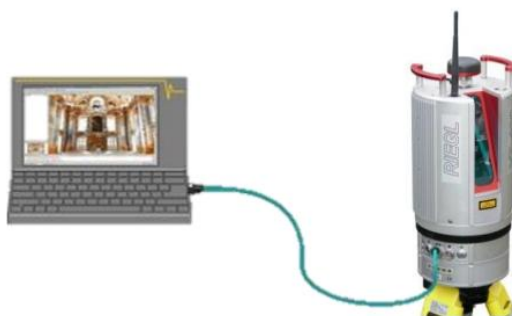
Slika 14: Povezava programa in skenerja (Riegl, 2013).
