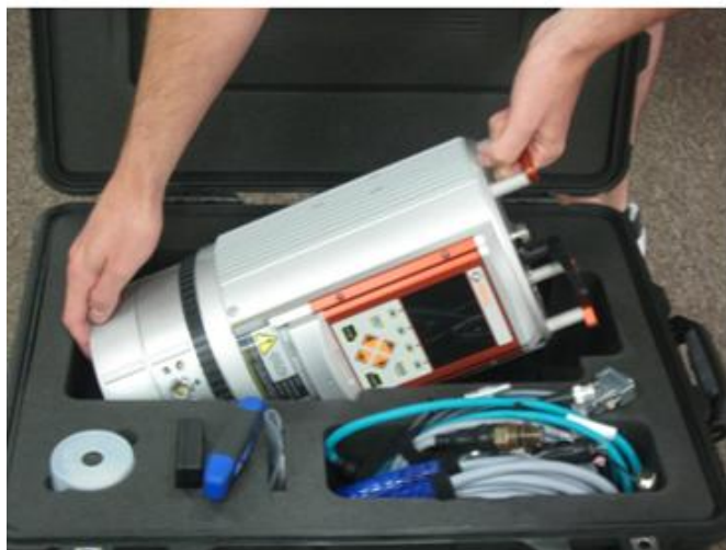
Slika 8: Pravilno shranjevanje skenerja (Riegl, 2013).
