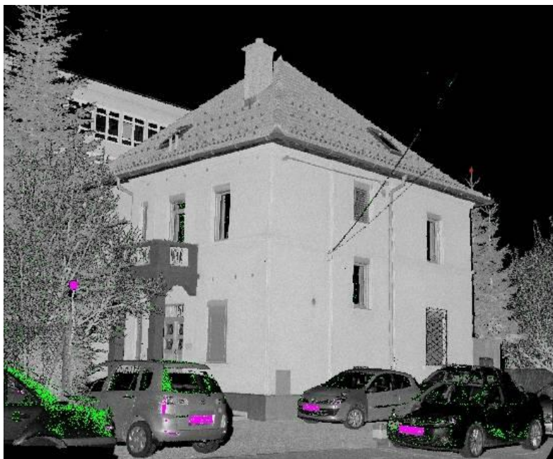
Slika 42: Skenogram, posnet s četrtega stojišča, v načinu prikaza reflektivnosti (min. -20 dB - zelena, max. 3 dB - roza).
