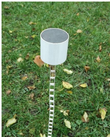
Slika 33: Rieglova tarča v obliki valja
