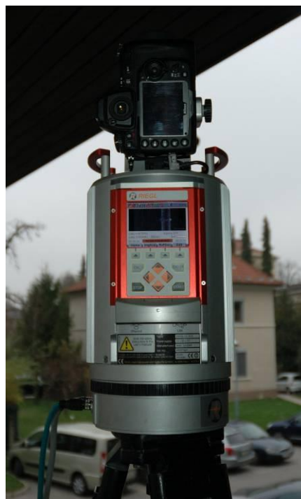
Slika 21: TLS Riegl VZ-400 (posneto na terenu v času skeniranja, 21. 11. 2012).
