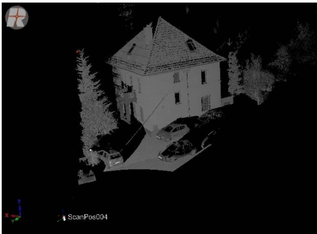
Slika 35: Neobdelan oblak točk (678.160 točk), posnet s četrtega stojišča.
