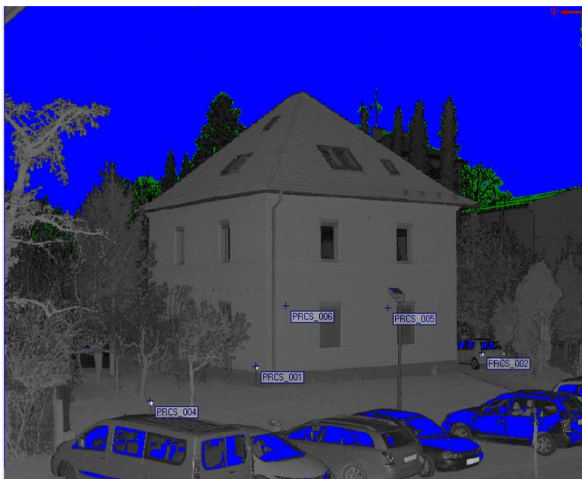
Slika 19: Razporeditev petih tarč okoli objekta, vidne s prvega stojišča skenerja. Slika je prikazana v 2D pogledu z načinom prikaza odbojnost, koordinate veznih točk so preračunane v projektni koordinatni sistem.
