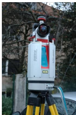
Slika 6: Na terestrični laserski skener pritrjen digitalni fotoaparati
