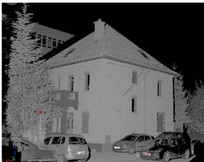
Slika 41: Skenogram, posnet s četrtega stojišča, v načinu prikaza amplitudnih vrednosti (min. 0 dB - zelena, max. 50 dB - rdeča).
