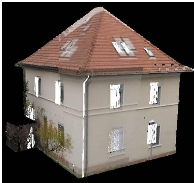
Slika 52: Primer filtriranega skenograma (595.737 točk) brez uporabe algoritmov za filtriranje.
