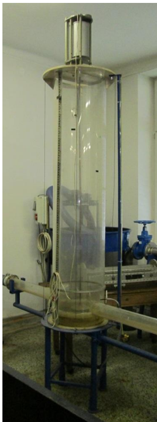
Slika 22: Model cilindričnega vodostana v hidravličnem laboratoriju Inštituta za hidravlične raziskave
