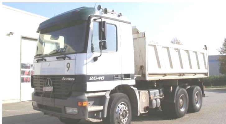
Slika 40: Kamion prekucnik za transport betona do mesta vgradnje
