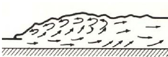
Slika 32: Stabilen vodni skok ob vznožju pregrade
