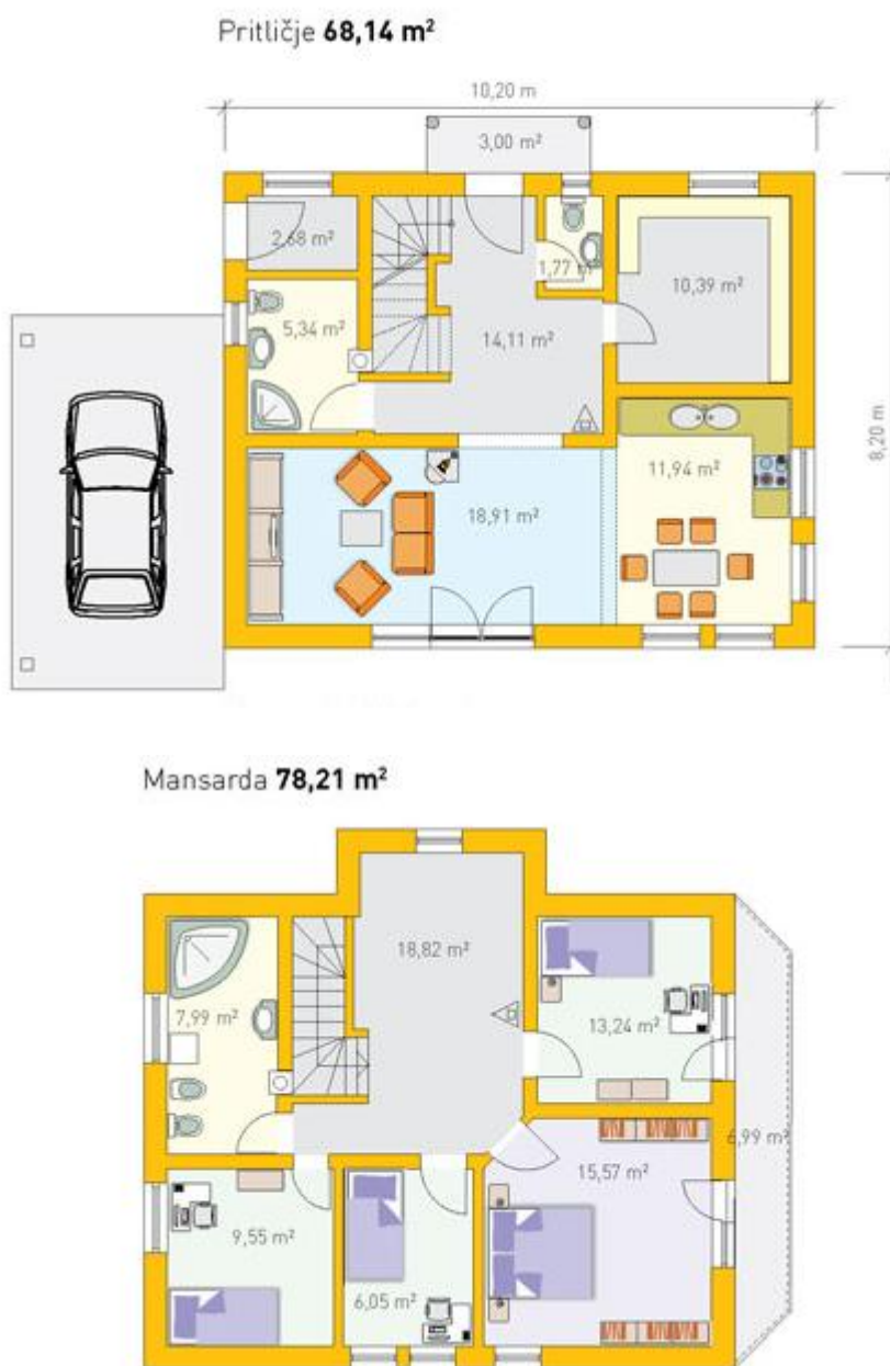
Slika 20: Tlorisi posameznih etaž enostanovanjske hiše št. 4 (Plan-net d.o.o., 2012)
