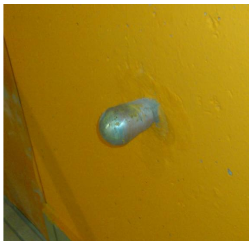
Slika 14: Nizki reper v strojnici hidroelektrarne
