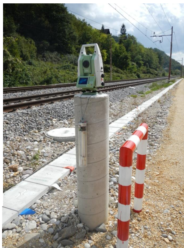
Slika 11: Referenčna točka O1 z zavarovanjem kot primer stabilizacije točk osnovne mreže
