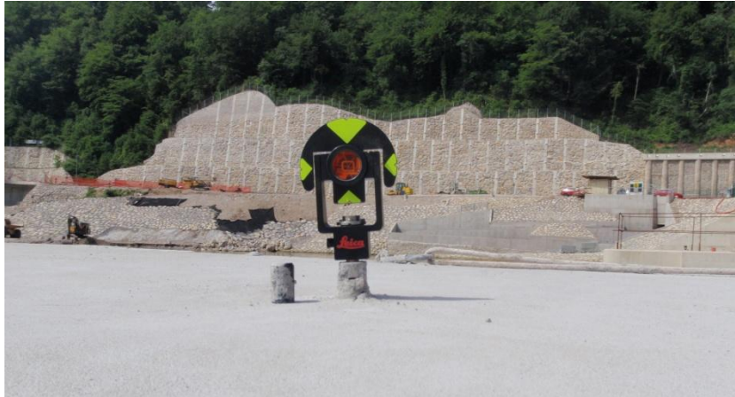
Slika 12: Stabilizacija kontrolne točke z nameščeno t. i. mini prizmo
