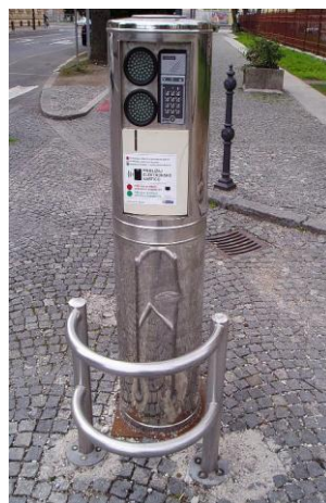
Slika 45: Avtomatski dvizni stebriček - fizična vrata, krmilnik za upravljanje stebrička Vir: Žura, M., »in sod.«, 2005, 112 (5.3.2012)
