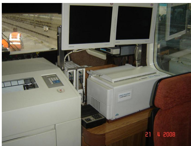
Slika 10: Računalnik v merilnem vlaku EM 120 z oznako FMK 004
