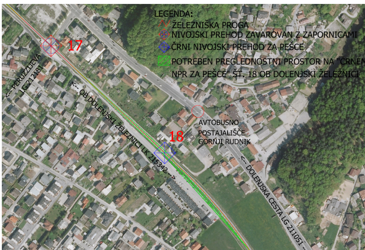
Slika 62: Prikaz potrebne preglednosti in prikaz lokacije črnega NPR za pešce št. 18. Ob Dolenjski železnici
