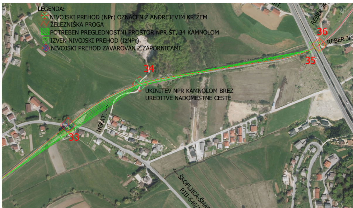
Slika 32: Potreben preglednostni prostor in predlog ureditve NPR Kamnolom
