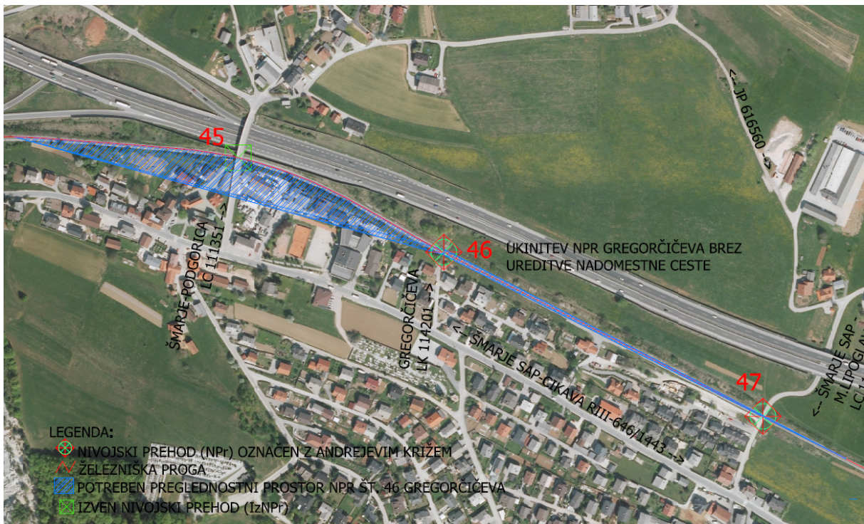
Slika 50: Potrebna preglednost in predlog ukrepa na NPr št. 46 Gregorčičeva
