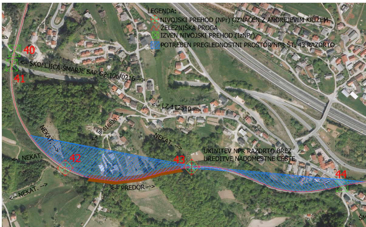
Slika 45: Potreben preglednostni prostor in predlog ukrepa na NPr št. 43 Razdrto
