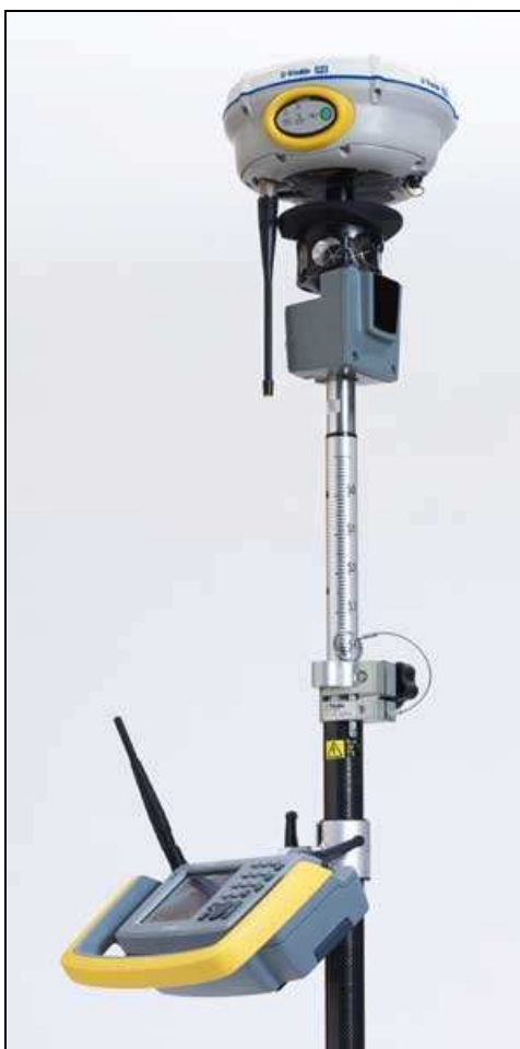
Slika 7 Rover, na katerem so GPS sprejemnik, prizma in kontrolna enota
