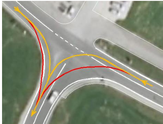
Slika 11: Problem sekane ovinkov (oranžna prikazuje pravi potek vožnje, rdeča pa napačnega)
