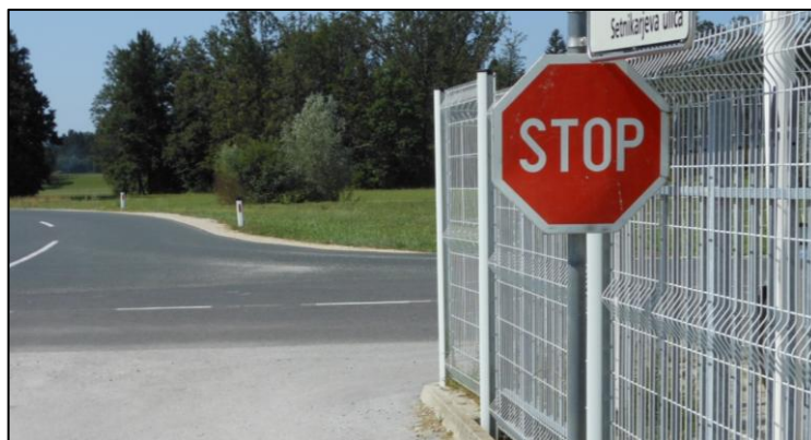
Slika 9: Ureditev priključitve kraka C na GPS z znakom II-2: "Ustavi!" ter prikaz slabe preglednosti v desno
