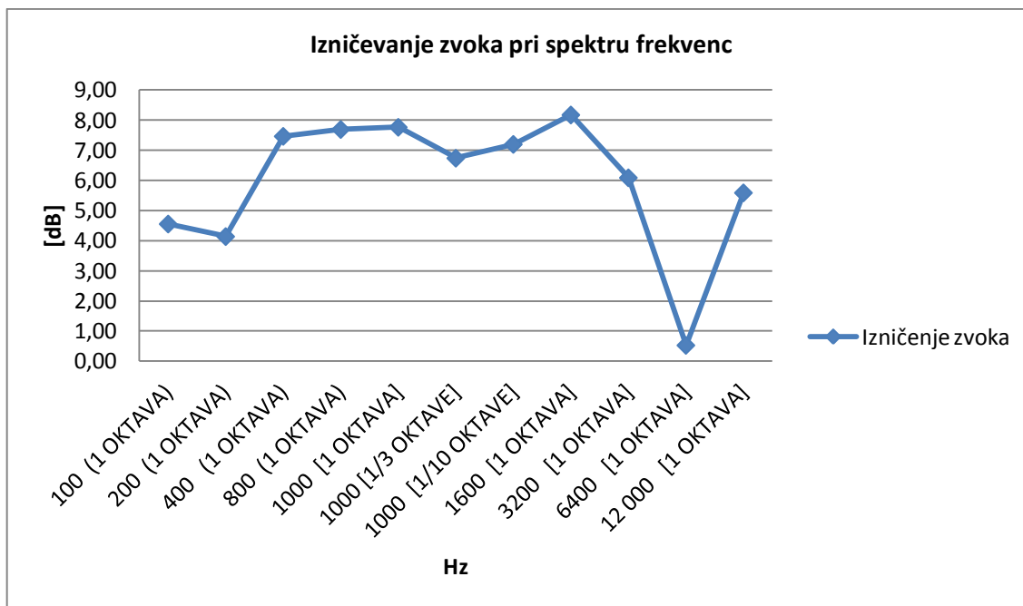
Grafikon 4: Izničevanje zvoka pri spektru frekvenc z zamenjavo faz
