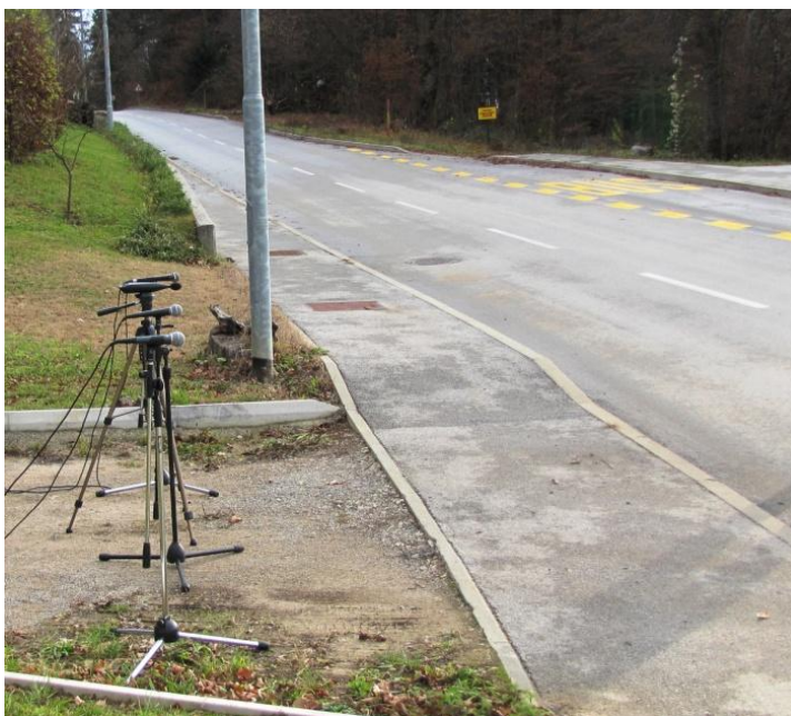
Slika 44: Postavitev mikrofonov ob cestišču
