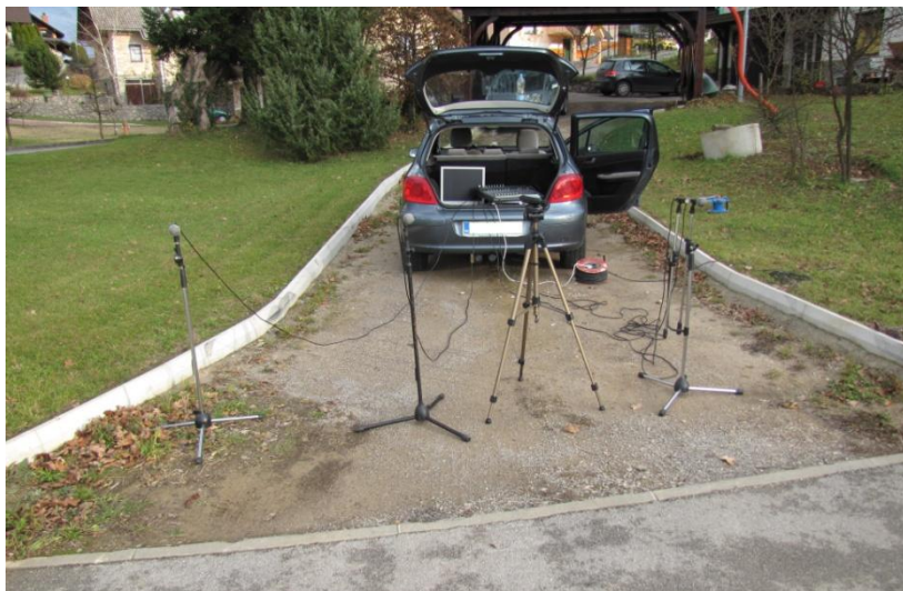
Slika 45: Postavitev mikrofona in snemalne opreme
