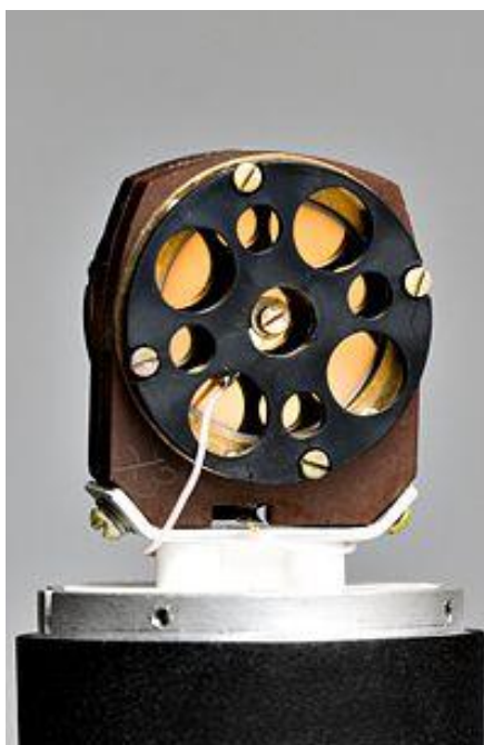
Slika 20: Notranjost kondenzatorskega mikrofona Oktava 319 ( http://sl.wikipedia.org/wiki/Kondenzatorski_mikrofon )
