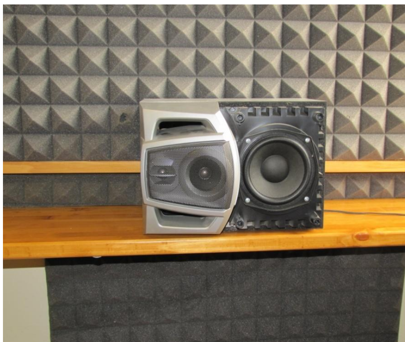
Slika 39: Postavitev zvočnika in v ozadju izolacija za preprečevanje odmeva zvoka
