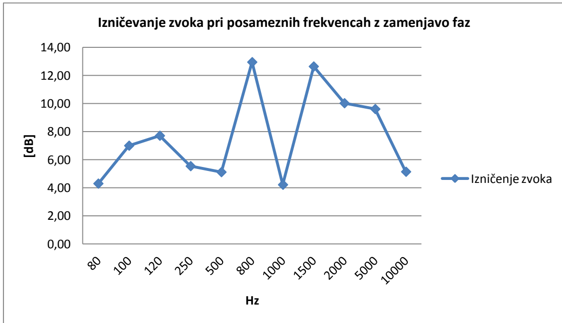
Grafikon 2: Izničevanje zvoka pri posameznih frekvencah z zamenjavo faz
