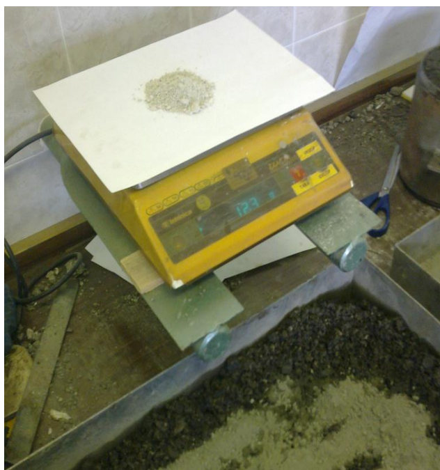
Slika 24: Priprava mešanice s cementom in kemijskim dodatkom
