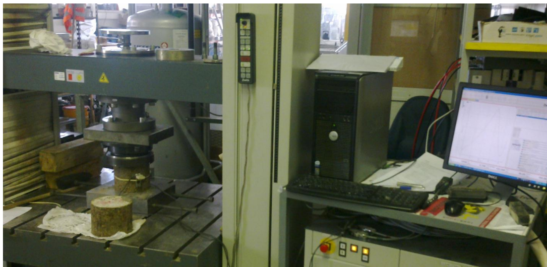
Slika 45: Preiskave modula elastičnosti je izvedel Igmtat, d. d., Inštitut za gradbene materiale
