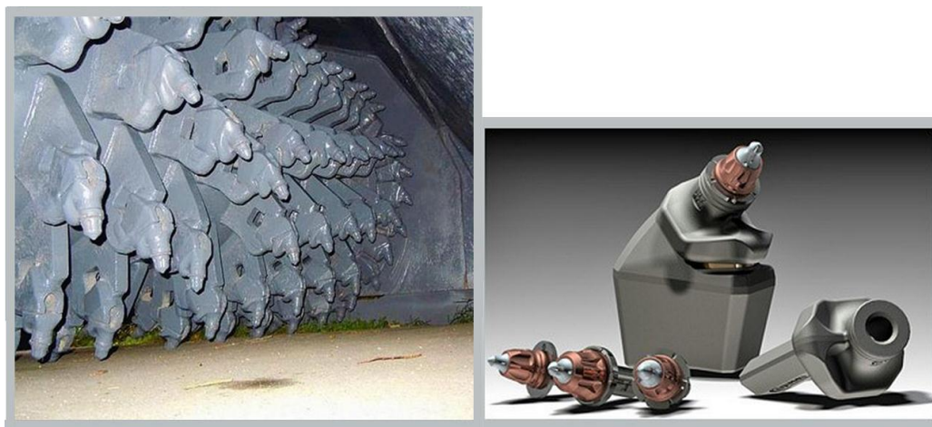
Slika 16: Rezkalni valj z noži za izkop (Wirtgen, 2010)
