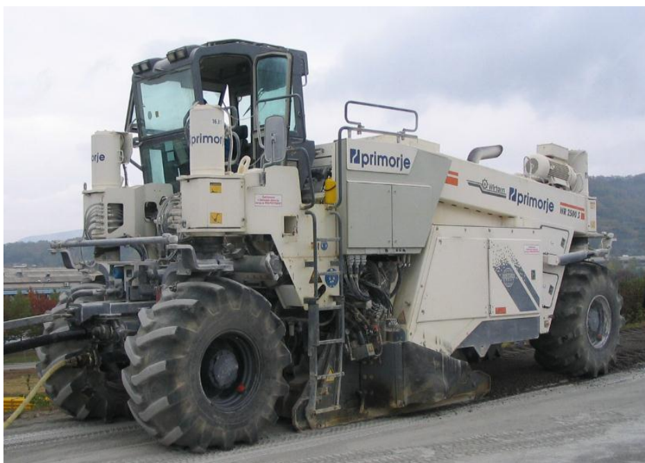
Slika 15: Obnova cest s hladno reciklažo na licu mesta (vir: Primorje)
