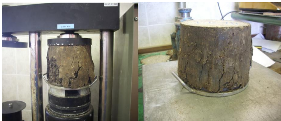
Slika 41: Primera primerne porušitve preskušancev po enoosni tlačni obremenitvi
