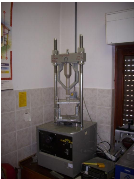
Slika 43: Stiskalnica za preizkušanje posredne natezne trdnosti
