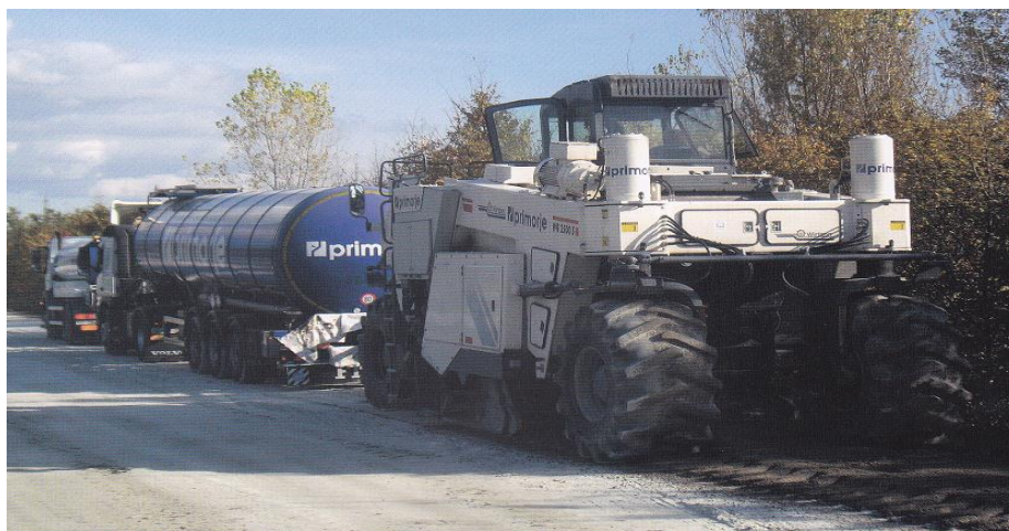
Slika 27: Reciklator WIRTGEN WR 2500 S pri izvedbi hladne reciklaže z uporabo penjenega bitumna (Primorje, 2006)
