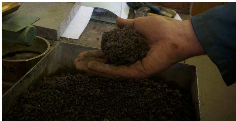
Slika 35: Kontrola vlage s kepo mešanice
