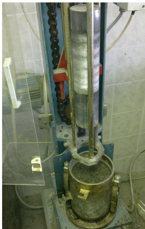
Slika 37: Izdelava preskušancev po Proctorju
