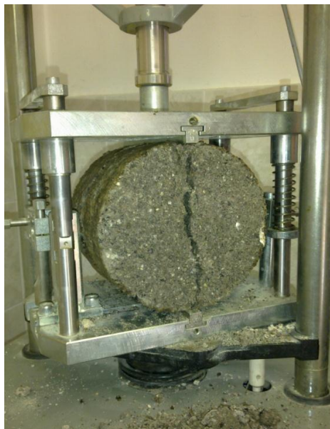
Slika 44: Primer primerne porušitve preskušanca
