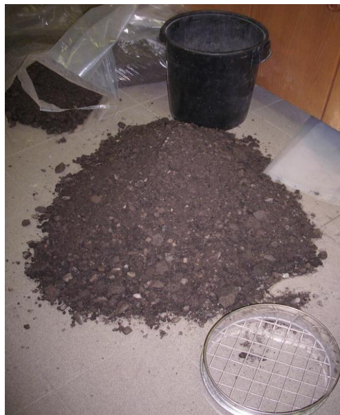
Slika 30: Reciklirana zmes zrn pred mešanjem z vezivi
