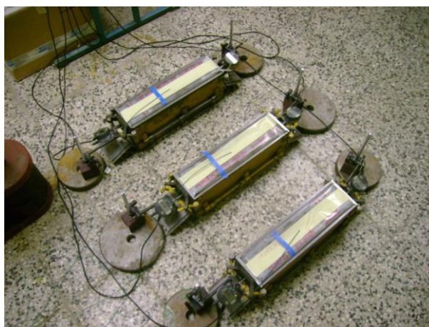
Slika 21: Elektronsko merjenje avtogenega krčenja preskušancev
