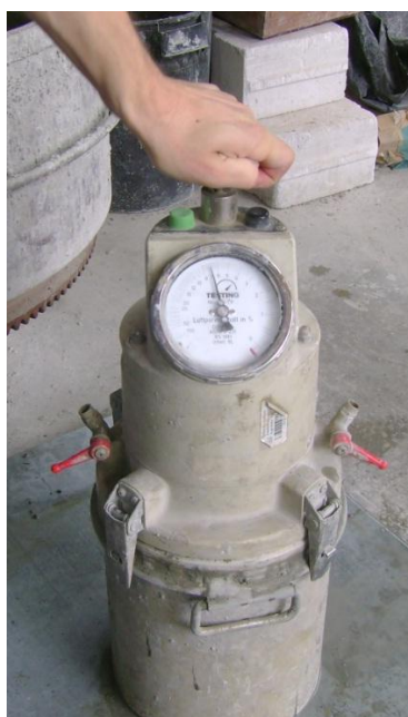
Slika 19: Naprava za merjenje vsebnosti zraka v betonu
