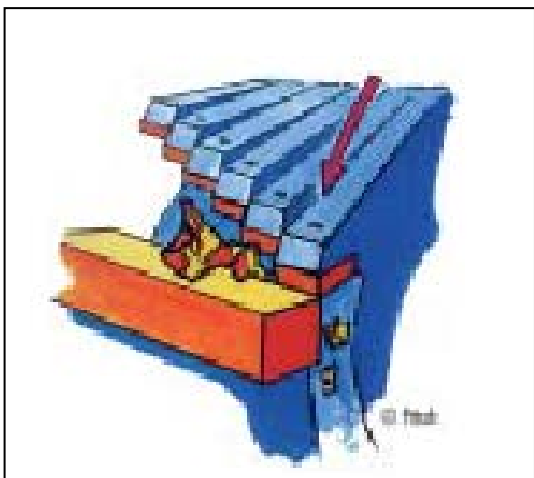
Slika 20: Delovanje šest kolutnega rotorja
