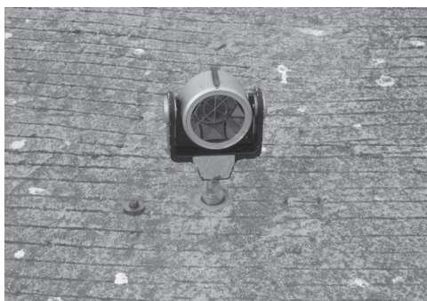
Slika 4: Stabilizacija in signalizacija referenčnih točk (levo) in ekscentričnih stojišč (desno).
