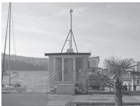
Slika 3: Kontrolna točka KOPE – antena GPS (levo) in reflektor (desno).
