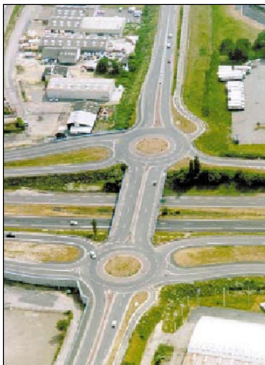
Slika 31 – Romb z dvema krožnima križiščema in z enim nadvozom ter okroglima centralnima otokoma – Francija ( http://www.tfrc.gov/safety/00-0678.pdf )
