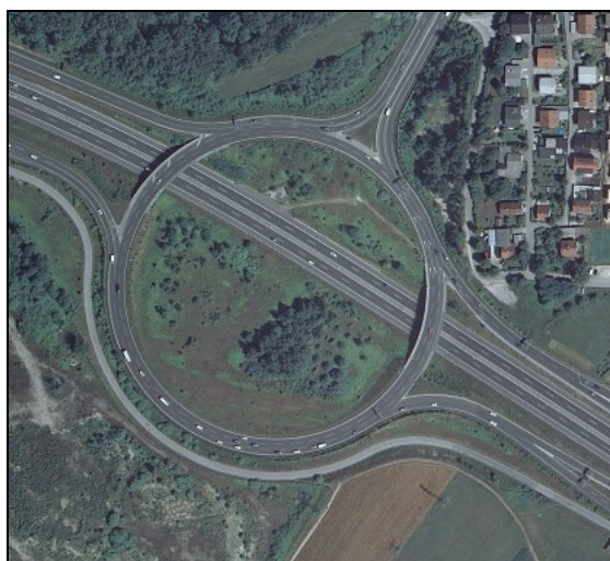
Slika 27 – Shema romba s krožiščem ( http://www.tfrc.gov/safety/00-0678.pdf )
