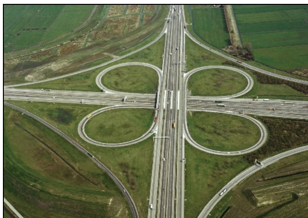
Slika 13 – Križanje v obliki deteljice s servisnimi cestami ( http://en.wikipedia.org/wiki/Cloverleaf_interchange )
