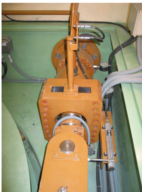
Meritev giba servomotorja vodilnika (Arhiv Litostroj Power d.o.o.)
