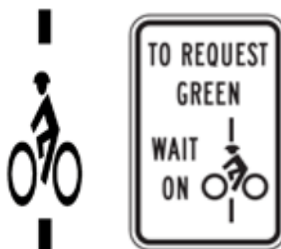
Slika 32: Znaki, ki se postavljajo na križišču opremljenim z detektorji – ZDA
