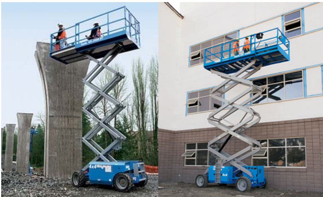
Slika 18: Škarjasti dvigali z lastnim pogonom vožnje (Genielift, 2010b)
