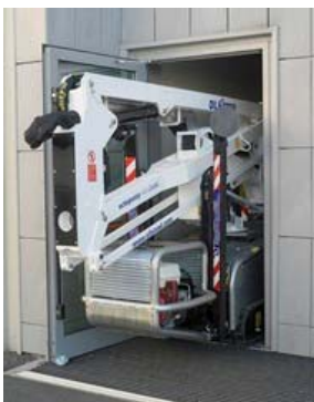
Slika 21: Ozko dvigalo na gosenicah za delo v zaprtih prostorih
