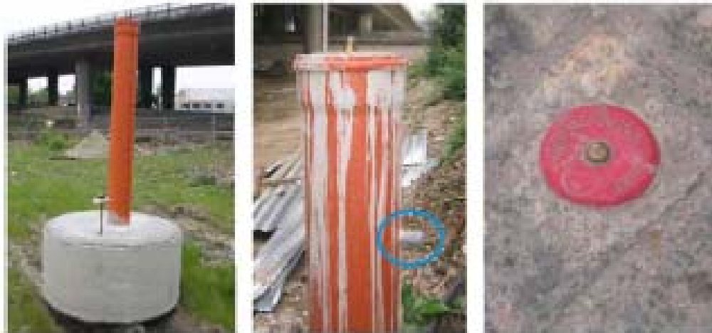
Slika 7: Stabilizacija izmeritvene mreže. Levo: Betonski podstavek s stebrom za prisilno centriranje pred zakopom v zemljo. Sredina: Steber za prisilno centriranje in reper za niveliranje. Desno: Kontrolna točka na betonskem podstavku. (Schäfer, 2008)
