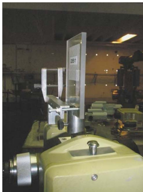
Slika 6: Pritrditev tarče na mikrometrsko mizo
