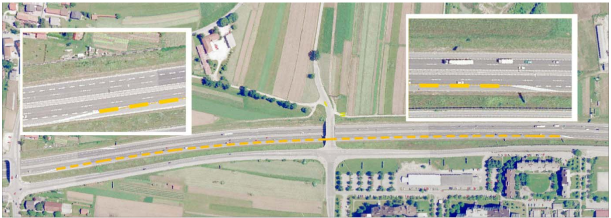
Slika 4-3: ITS ukrep uporabe odstavnega pasu na kratkem odseku Tomačevo-Šmartinska
