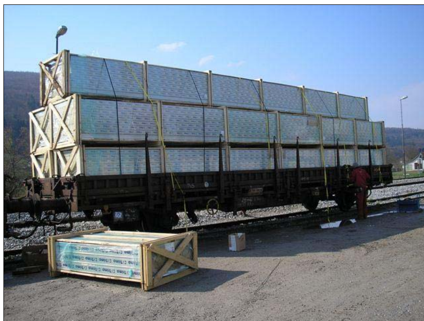
SLIKA 28: Vagonski transport panelov (Vir: Interno gradivo TRIMO, d.d.)
