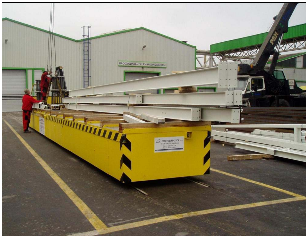
SLIKA 19: Transportna ploščad za iznos JK, nosilnosti 200 kN
