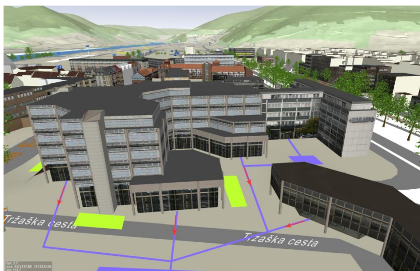
Slika 28: Evakuacijske poti (modro) iz stavb do varne površine (modra površina) in delovnih površin za gasilska vozila (zeleno).
