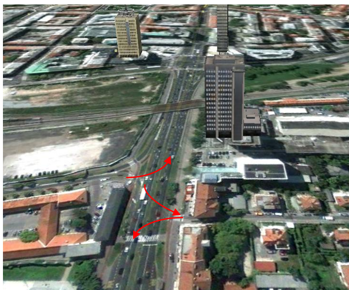
Slika 45: Cestni element z oviro med voznima pasovoma, ki fizično preprečuje manevre, označene z redečo puščico.
