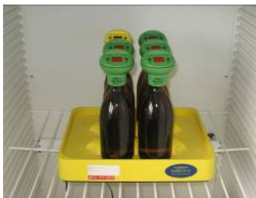
Slika 4: Izvajanje meritev BPK 5 (23.11.2007)
