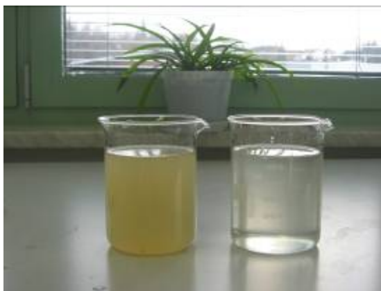
Slika 32: Razlika v barvi in bistrosti dotočne odpadne vode in očiščene vode iz ČN SBR 5
