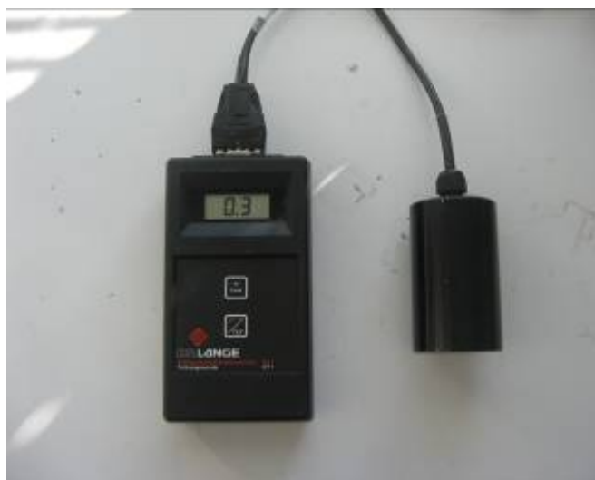
Slika 6: Merilnik sušine blata (27.11.2007)
