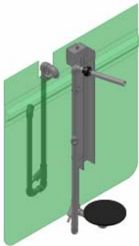
Slika 20: Cevni razvod – mamut črpalke (vir: Regeneracija d.o.o.)
