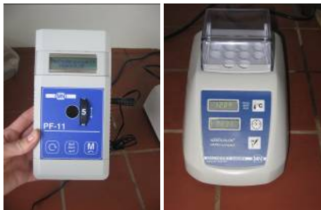
Slika 3: Nanocolorjeva grelna naprava in fotospektrometer, za merjenje parametrov odpadne vode (23.11.2007)
