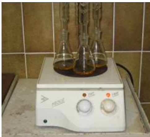
Slika 2: Izvajanje meritev KPK ( 23.11.2007 )
