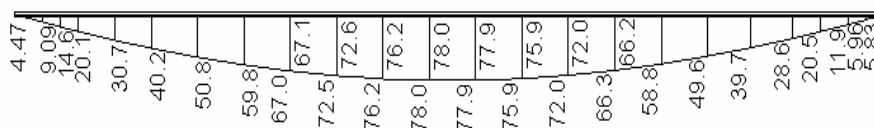
Slika 74: Upogibni momenti nosilca; primer 3c [kNm]
