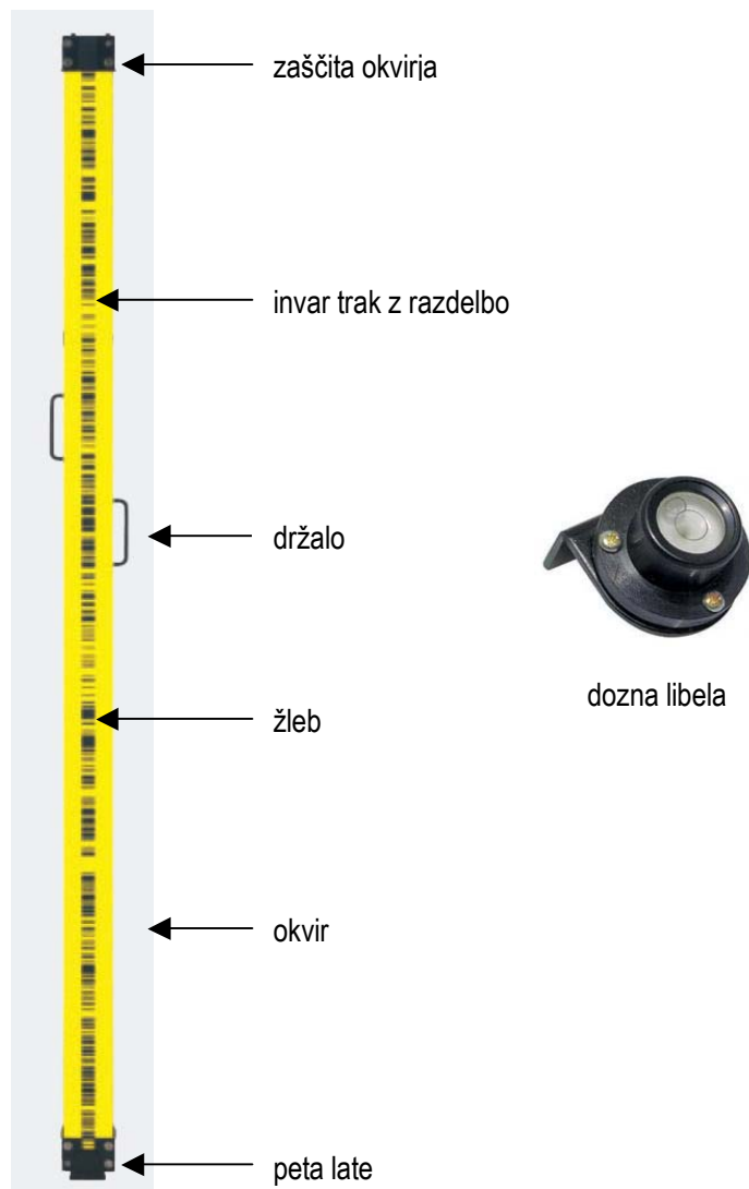
Slika 2.4: Zgradba precizne invar nivelmanske late
