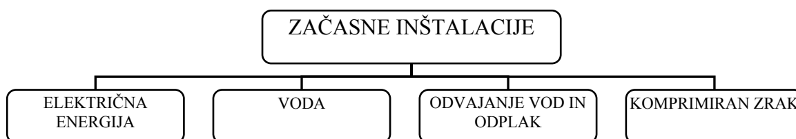
Slika 8: Začasne inštalacije na gradbišču
