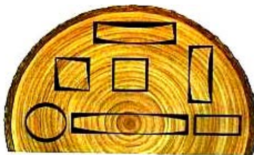
Slika 3.2.1: Deformiranje oblike izrezanega lesa med krčenjem zaradi sušenja.
