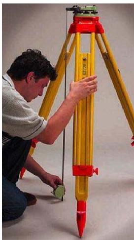
Slika 14: Uporaba tračnega metra Leica GHM007 za določitev višine instrumenta
