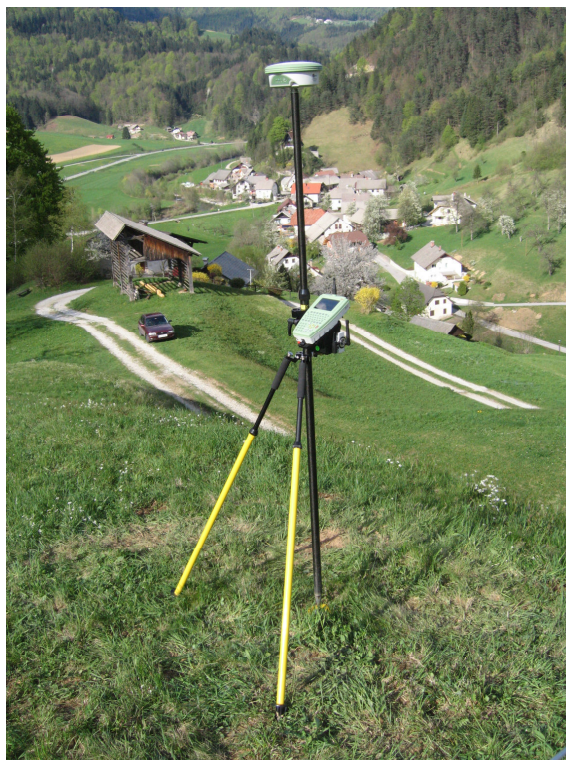
Slika 7: Sprejemnik na togem grezilu z dvonožnikom (Leica SmartRover)
