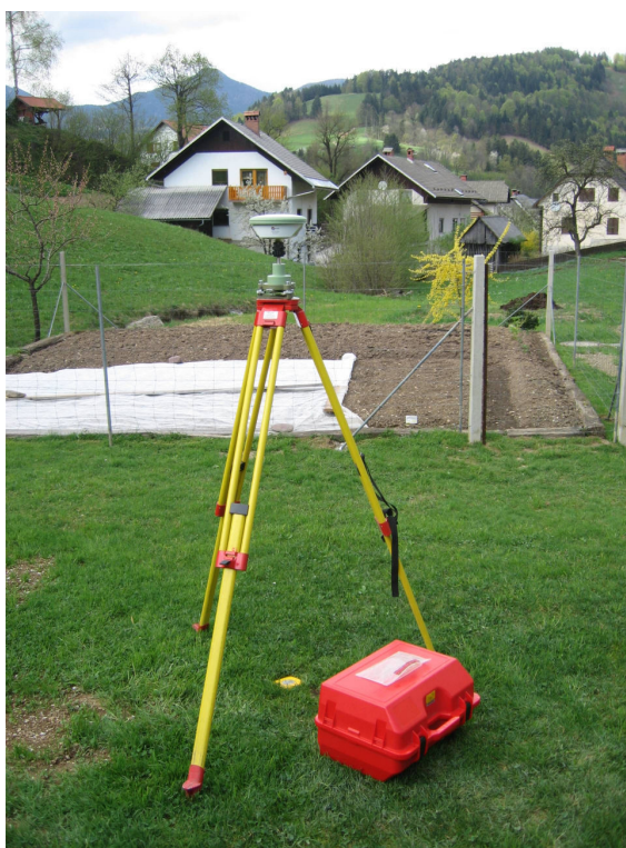
Slika 6: Postavitev antene GNSS nad točko pri statični izmeri
