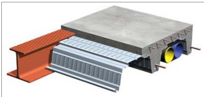
Slika 33: Inovativna rešitev Slimdeck za horizontalno nosilno konstrukcijo. 15
