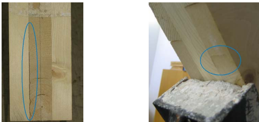
Slika 28: Porušitve diagonalnih preiskav preizkušancev
