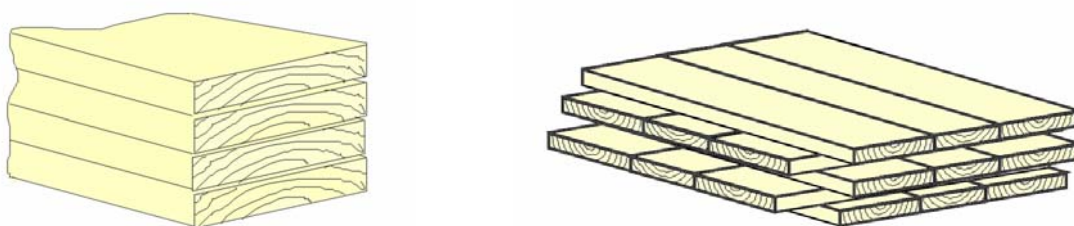
Slika 4: Enoplastno in križno večplastno lepljene lesene lamele
