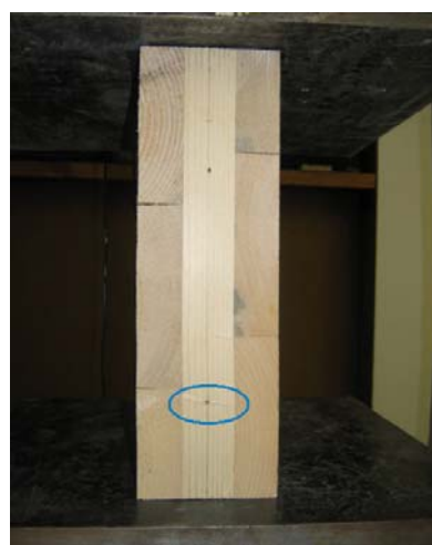
Slika 24: Porušitev preizkušanca obremenjenega vzporedno oz. pravokotno na smer vlaken zunanjih plasti
