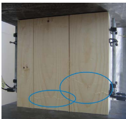
Slika 24: Porušitev preizkušanca obremenjenega vzporedno oz. pravokotno na smer vlaken zunanjih plasti
