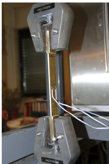
Slika 7.14: Prikaz preizkušanca, natančno vpetega v vpenjalne čeljusti
