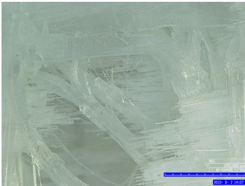
Slika 7.23: Pogled na porušitev steklenega kompozita: 50-kratna povečava
