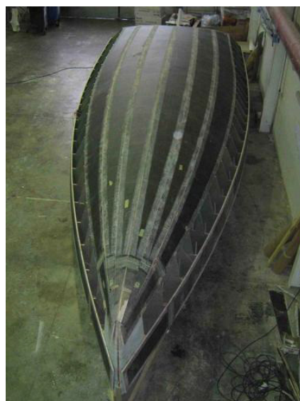
Slika 1.4 in 1.5: Levo: deski za jadrnanje na deski, narejeni s kombinacijo lanenih in karbonskih tkanin. Desno: primer izvedbe trupa jadrnice z uporabo lanene tkanine.
