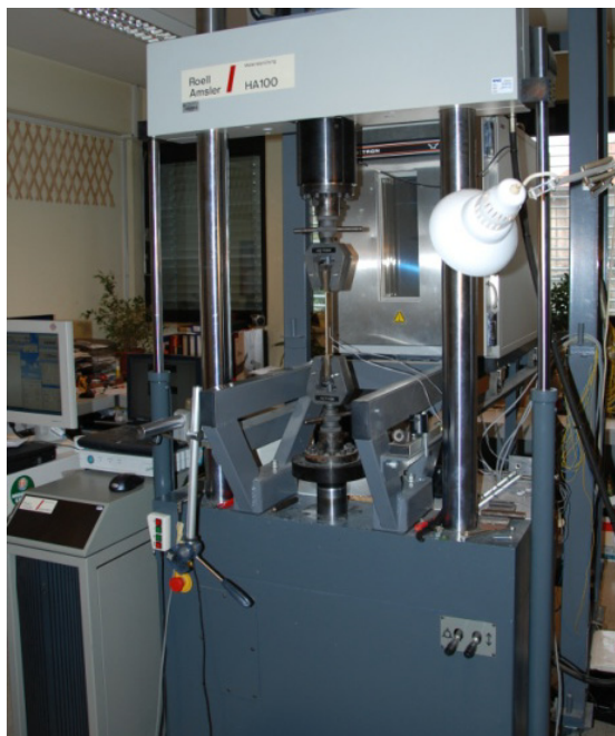
Slika 7.1: Preizkuševalni okvir Roell Amsler laboratorija Katedre za preizkušanje materialov in konstrukcij Fakultete za gradbeništvo in geodezijo v Ljubljani
