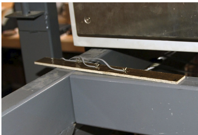
Slika 7.12: Kontrolni vzorec za sprotno korigiranje ambientalnih deformacij
