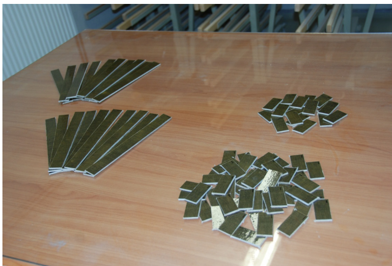
Slika 7.7: Izrezani preizkušanci in vpenjalne ploščice pripravljene za lepljenje
