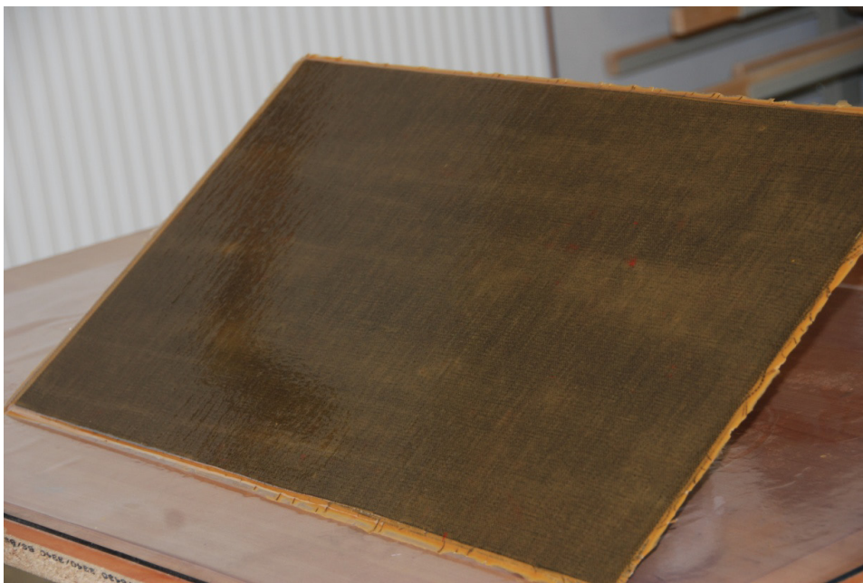
Slika 7.6: Laneni laminat, pripravljen za izrez preizkušancev – epoksi smola za sanacije lesenih konstrukcij
