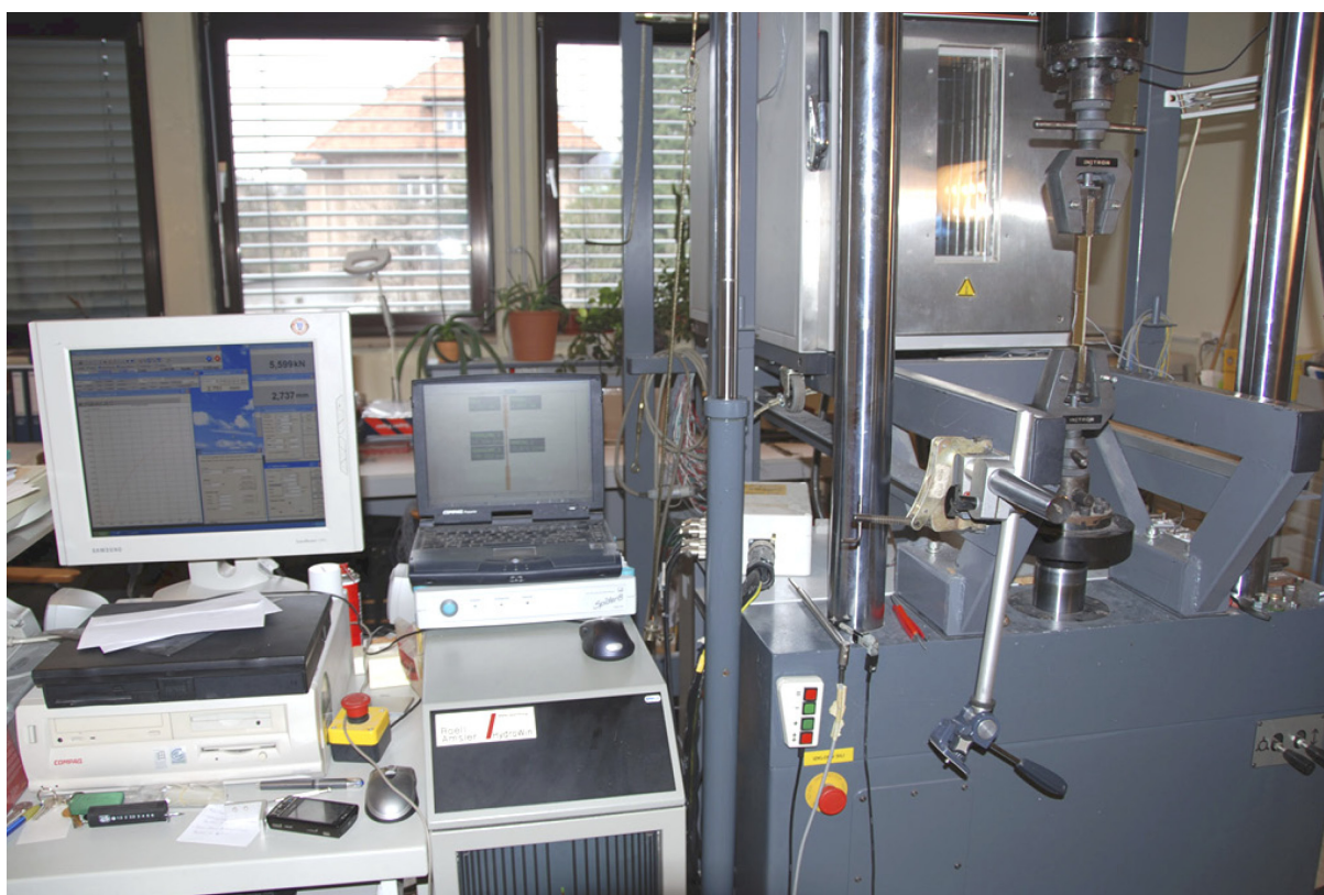
Slika 7.15: Preizkuševalni okvir s preizkušancem ter računalniške enote za vodenje in spremljanje preiskave
