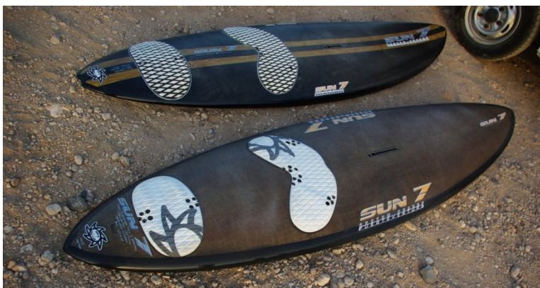
Slika 1.4 in 1.5: Levo: deski za jadrnanje na deski, narejeni s kombinacijo lanenih in karbonskih tkanin. Desno: primer izvedbe trupa jadrnice z uporabo lanene tkanine.
