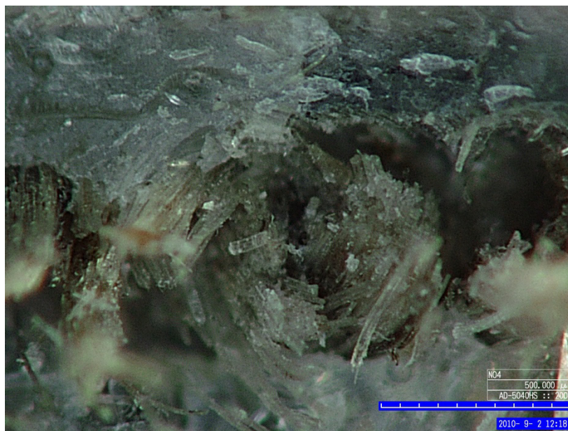
Slika 7.22: Detajl lanene niti pri 200-kratni povečavi, kjer se vidi oblitost tehničnih vlaken s polimerno matrico
