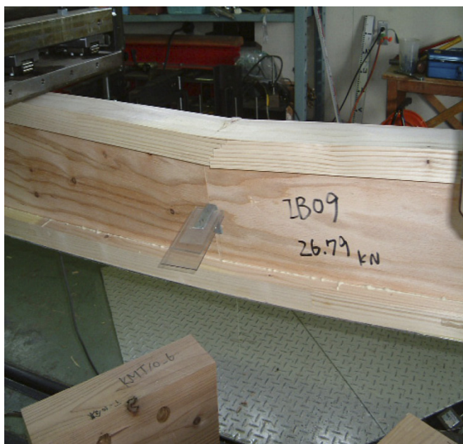
Slika 1.6: Tlačna porušitev zgornje pasnice I-nosilca pri upogibni obremenitvi kot posledica ojačitve spodnje pasnice s tkanino iz naravnih vlaken (Chui H. Y, et al. 2008)
