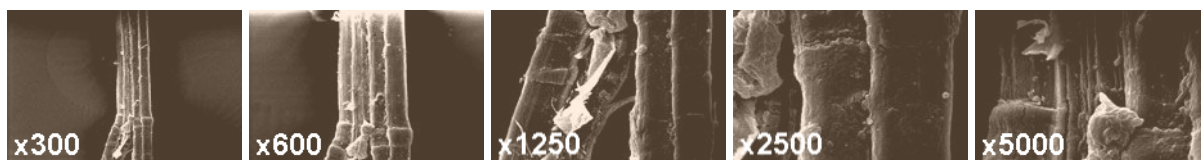
Slika 4.31: Sisalovo vlakno pod 300, 600, 1250, 2500 in 5000-kratno povečavo
