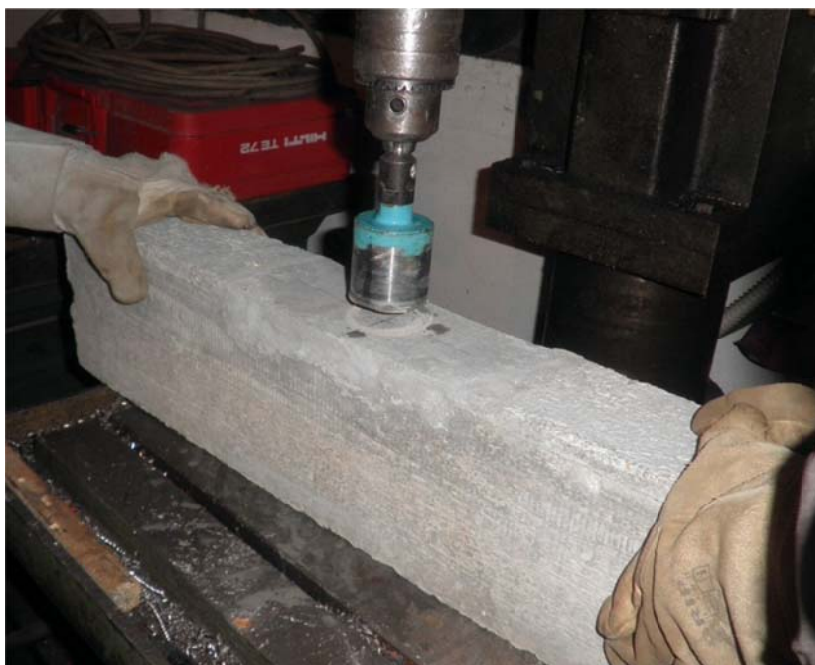
Slika 43: Vrtanje z diamantno žago skozi malto do betona
