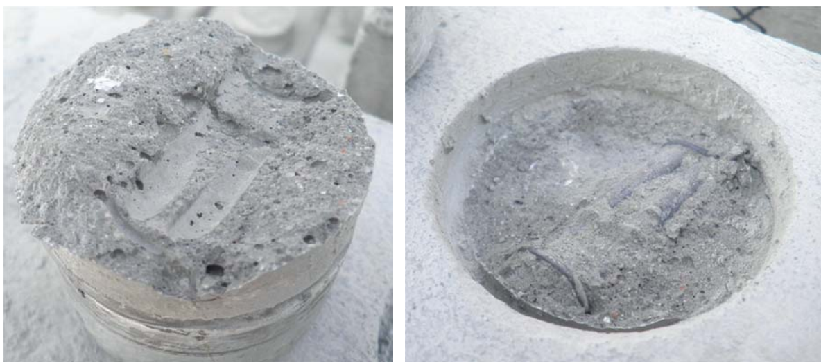
Slika 52: Prikaz porušenih površin Pull-off testa pri vzorcu 4 (malta Emaco NanoCrete R3 in ročna obdelava betonske površine)
