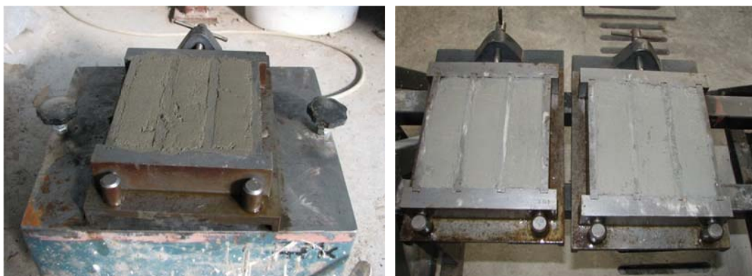
Slika 28: Vibriranje kalupov na vibracijski mizi (levo) in pripravljene vzorce (desno)
