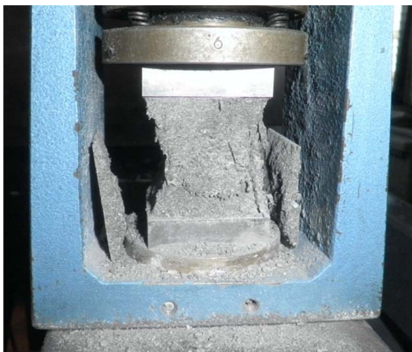
Slika 34: Rušenje vzorca med preiskavo tlačne trdnosti
