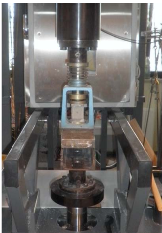
Slika 33: Jekleni okvir za preizkus tlačne trdnosti vzorcev
