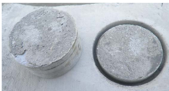
Slika 48: Prikaz porušenih površin Pull-off testa pri vzorcu 2 (malta Emaco S80 in ročno obdelana betonska površina). Dobro je vidno da se je porušitev zgodila v sloju takoj pod lepilom
