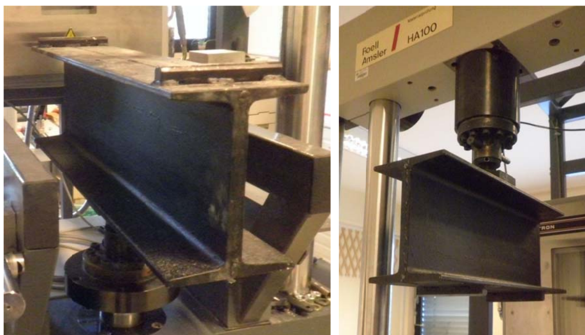
Slika 26: Jeklena elementa za vnos obremenitev v armiranobetonske preskušance
