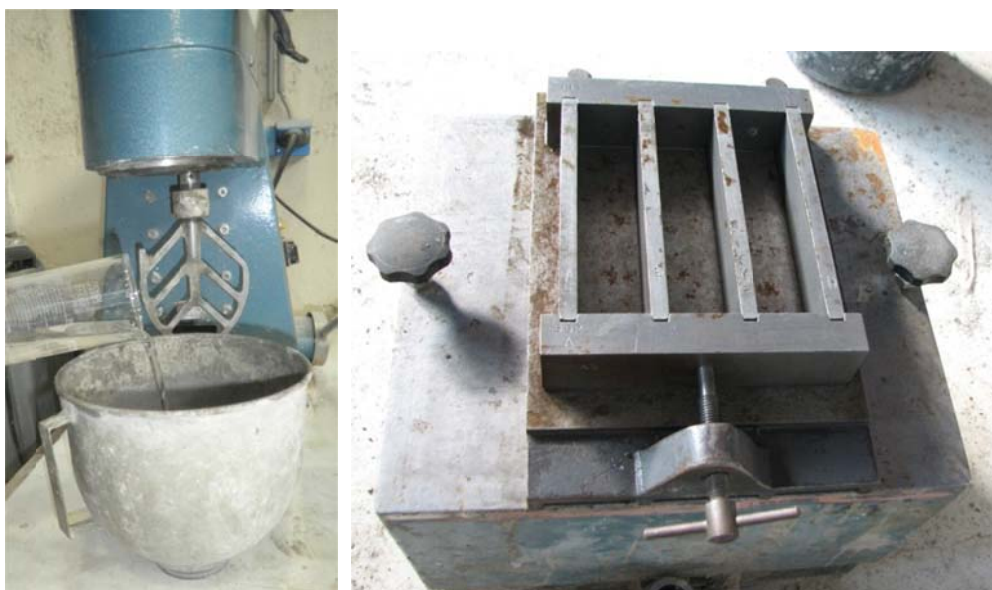
Slika 27: Standardizirani mešalec in kalup za izdelavo vzorcev
