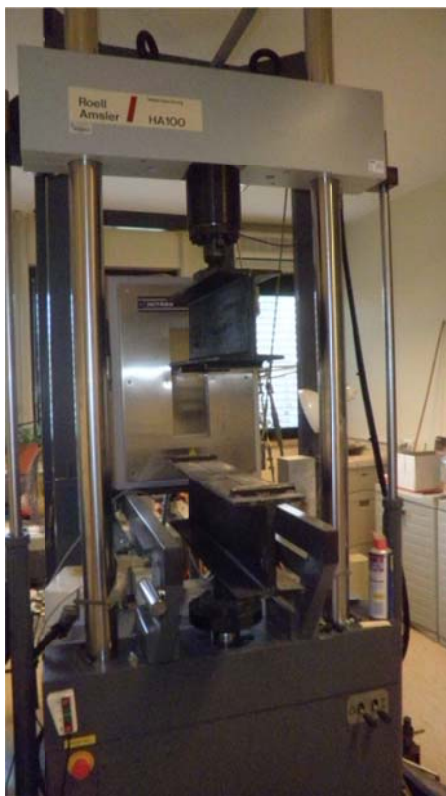
Slika 17: Preizkuševalna naprava Roell-Amsler HA100, s katero so bile opravljene preiskave na betonskih gredah/nosilcih
