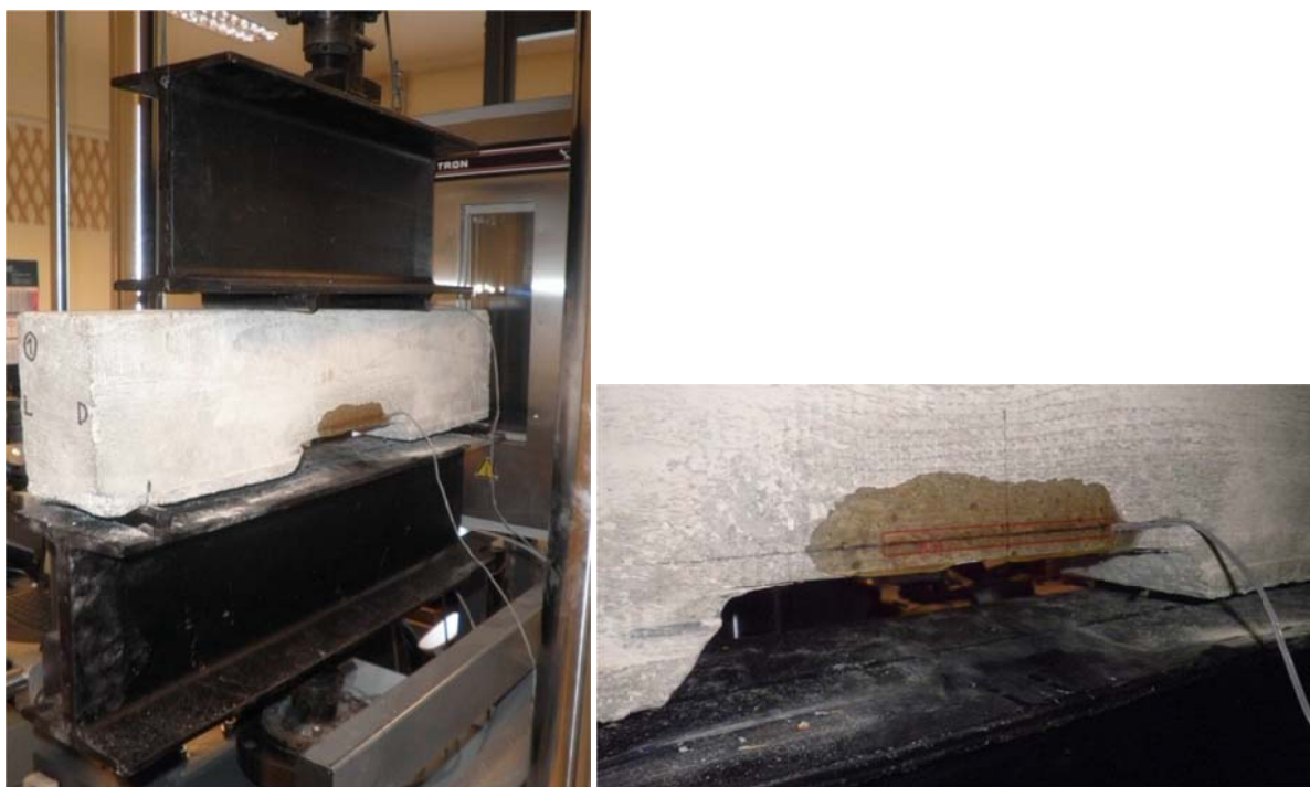
Slika 19: Določanje začetne sile obremenjevanja z uporabo lističev »strain gauge«. Iz slike je razvidno, da so lističi nameščeni ob straneh oslabiljenega dela prereza, na mestu največjega upogibnega momenta, torej na sredini razpona
