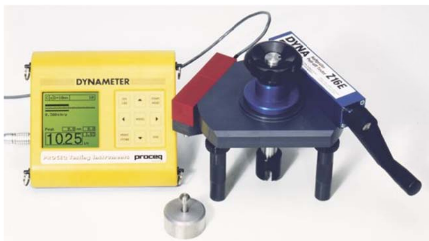
Slika 44: Merilna naprava, s katero so bili opravljeni testi odtržne trdnosti
