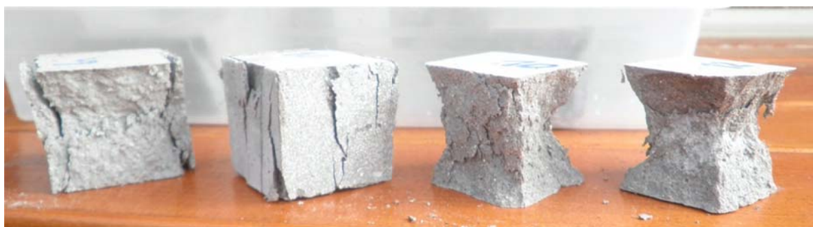
Slika 35: Različni načini porušitev vzorcev pri preiskavi tlačne trdnosti
