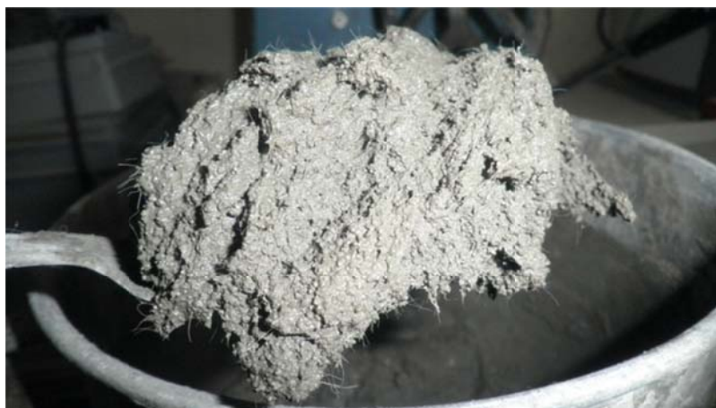
Slika 36: Malta pripravljena za nanos na betonski vzorec
