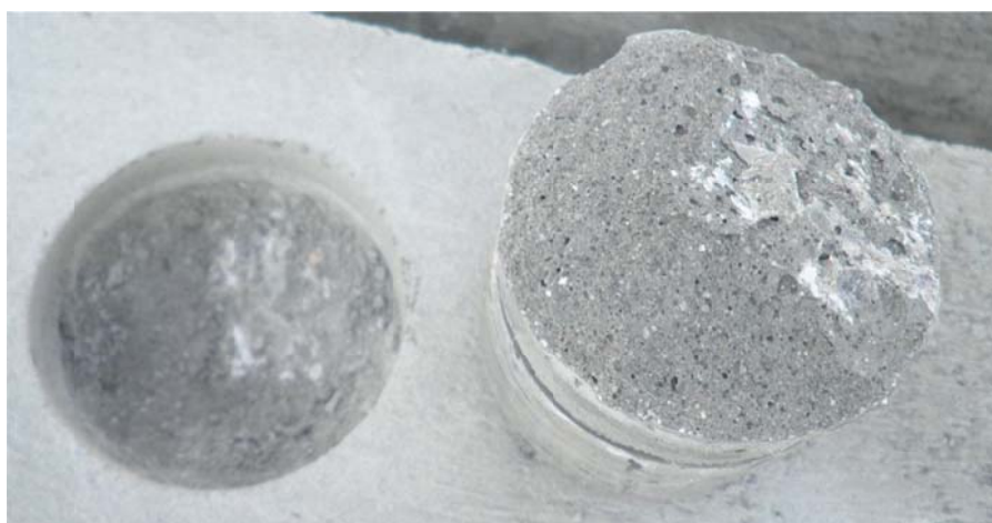
Slika 54: Prikaz porušenih površin Pull-off testa pri vzorcu 6 (malta Emaco NanoCrete R3 in ročna obdelava betonske površine)
