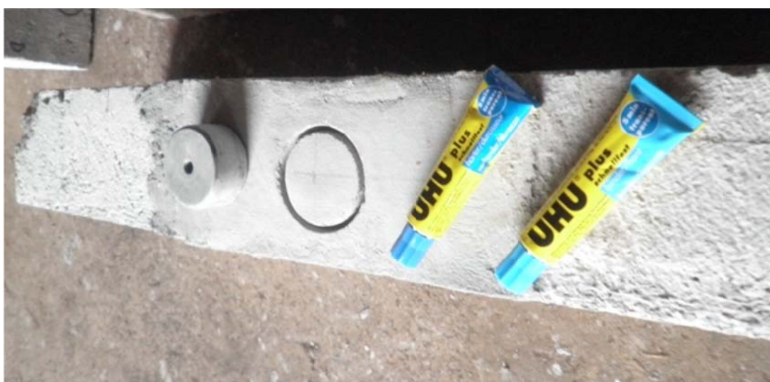
Slika 45: Betonski vzorec z izvrtano luknjo, jekleni čep in obe komponenti lepila
