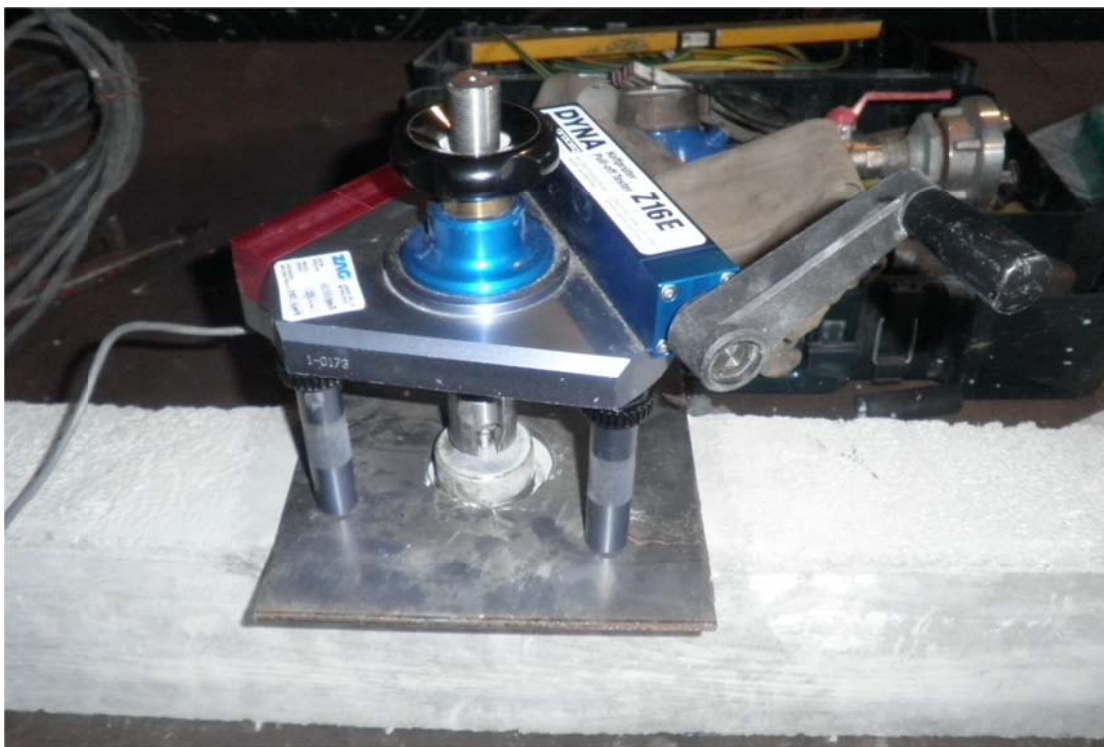
Slika 46: Postopek meritve odtržne trdnosti po metodi Pull-off. Vidna je jeklena plošča, ki je služila za podporo nogic preizkuševalne naprave.
