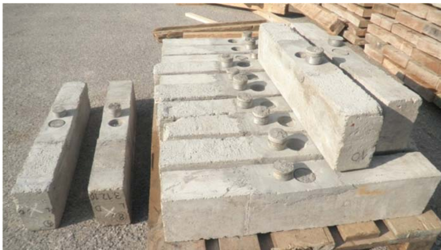
Slika 47: Betonski vzorci po končanih Pull-off testih s pripadajočimi jeklenimi čepi
