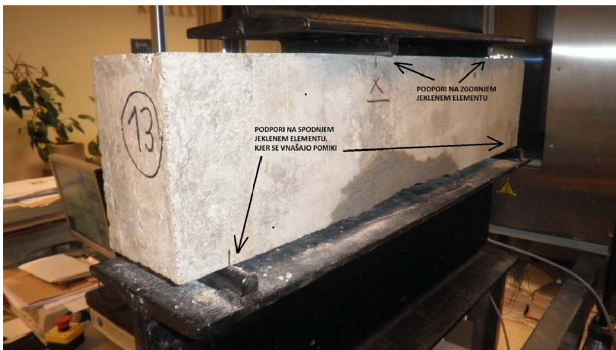
Slika 23: Prikaz dejanske situacije med dinamičnim obremenjevanjem
