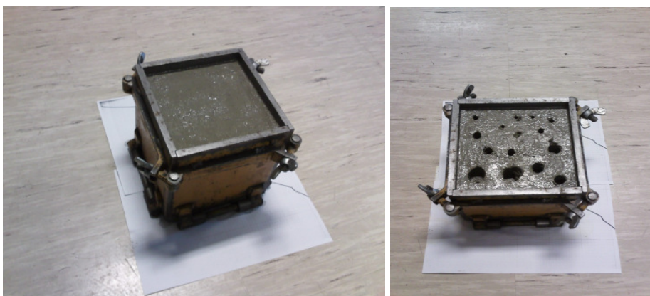
Slika 19: Kalupi z malto po vtiskanju igel.
