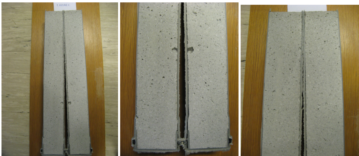
Slika 34: Vizualna ocena homogenosti strjenega 1. vzorca malt.
