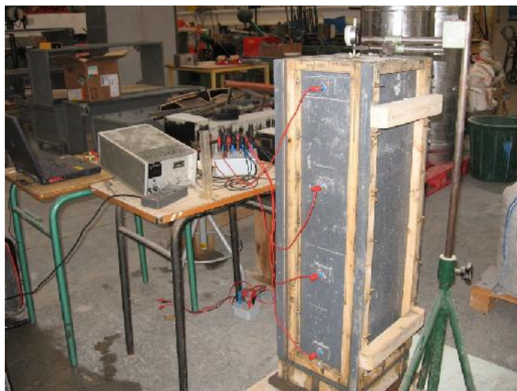
Slika 20: Testni vzorec z nameščenimi 4 pari elektrod.
