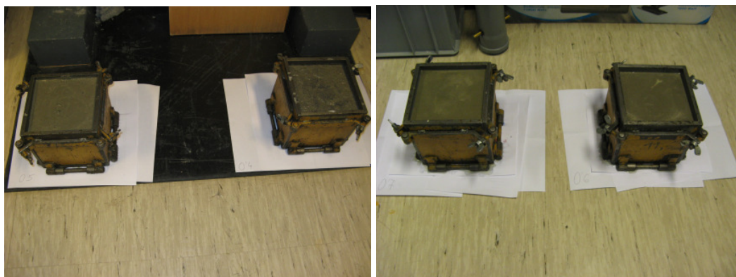
Slika 50: Vzorci z malto različnih v/c razmerji.
