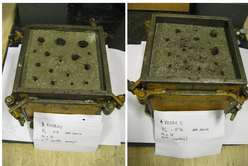
Slika 52: 3. in 4. vzorec malte z v/c razmerjem 0,5 in 0,4.
