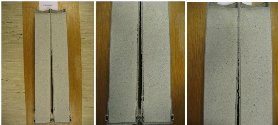
Slika 42: Vizualna ocena homogenosti strjenega 5. vzorca malte.
