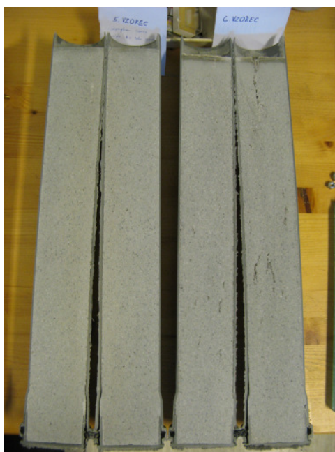
Slika 44: Vizualna ocena homogenosti dveh vzorcev s superplastifikatorjem.
