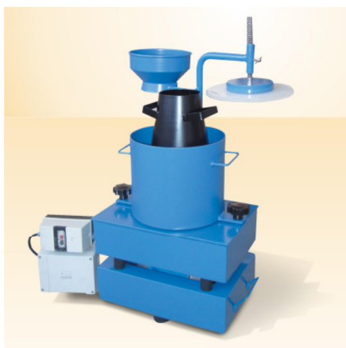
Slika 14: Ve-be metoda po SIST EN 12350-3.
