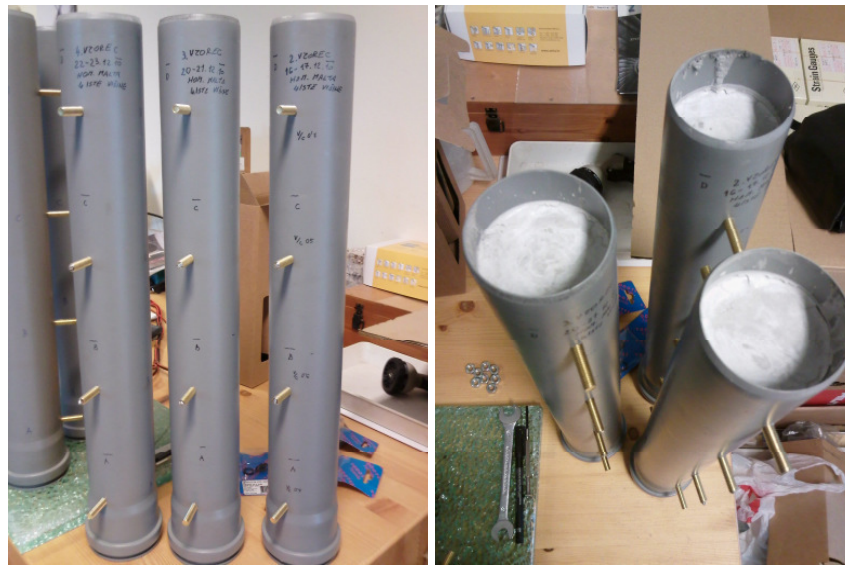
Slika 39: Vsi vzorci malt z različnim v/c po plasteh.
