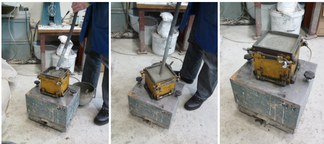
Slika 48: Zgoščevanje z vibracijsko iglo in na vibracijski mizici.
