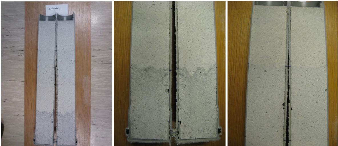
Slika 37: Vizualna ocena homogenosti strjenega 3. vzorca.
