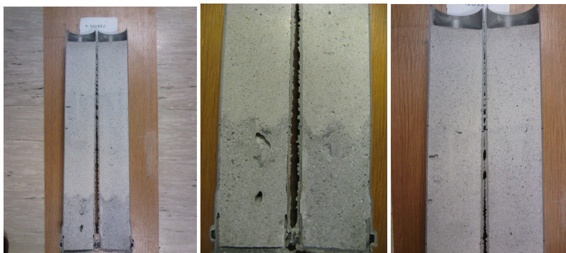
Slika 38: Vizualna ocena homogenosti strjenega 4. vzorca.
