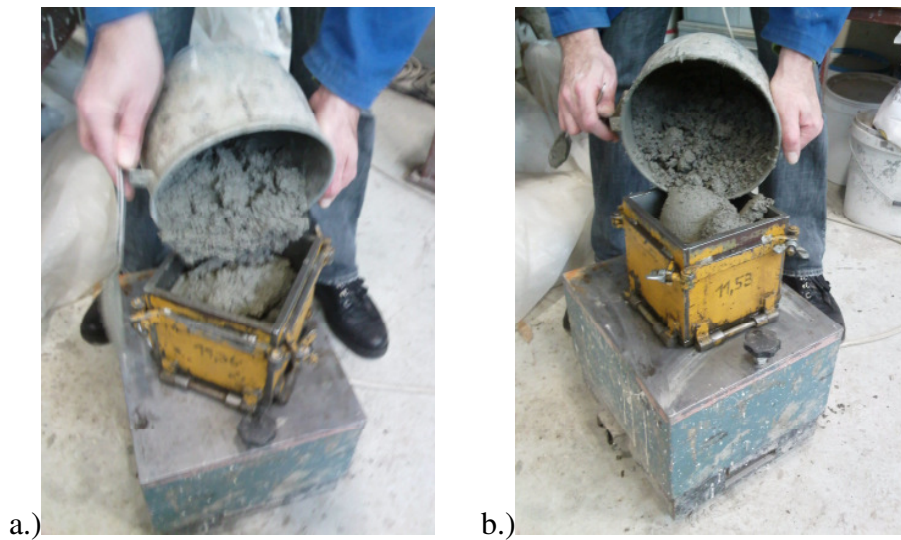
Slika 47: a.) vgrajevanje malte z v/c 0,5 b.) malte z v/c 0,4.
