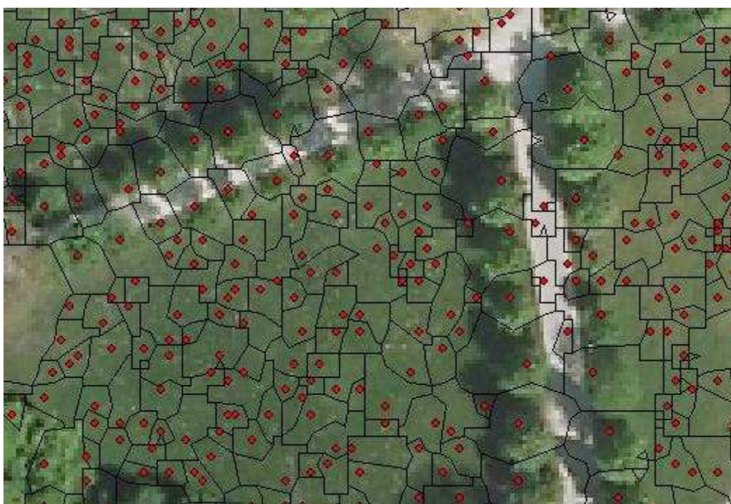
Slika 38: Izhodna sloja postopka inverzne razvodne segmentacije. Rdeče pike ponazarjajo vrhove, črne črte pa razvodja, t.j. meje med porečji.
