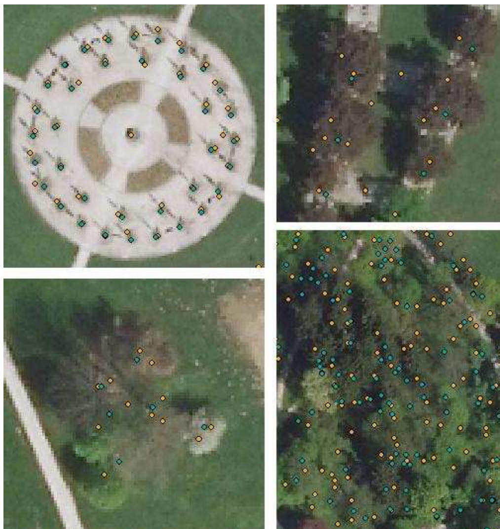
Slika 40: Značilnosti iskanja vrhov. Levo zgoraj: visok odstotek ujemanja med referenčnimi podatki (modre pike) in slojem vrhov (oranžne pike) za posamična drevesa z velikimi krošnjami. Desno zgoraj: večje število zaznanih vrhov, značilno za listavce. Levo spodaj: položajna neustreznost referenčnih podatkov. Desno spodaj: drevesa v skupini.
