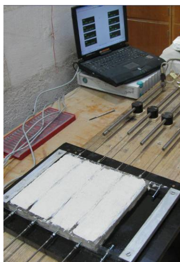
Slika 4.37: Povprečne deformacije malt M1 in M3a zaradi krčenja – prikaz postopka in rezultati Fig. 4.37: Average deformations due to shrinkage of mortars M1 and M3a – measurement procedure and results
