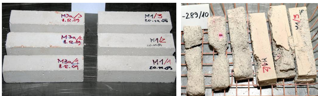
Slika 4.6: Maltne prizme pred (levo) in po 4 ciklih zmrzovanja/tajanja po »JUS postopku«(desno)
