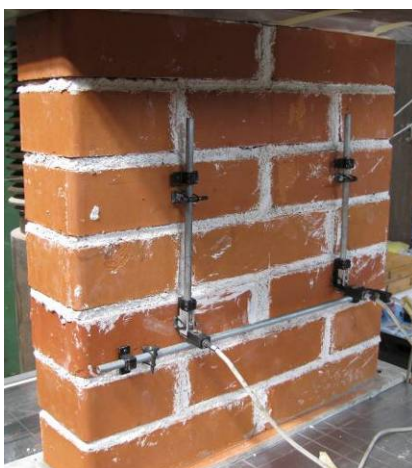
Slika 4.47: Prikaz merilnih mest na zidku M3a-2 neposredno pred izvedbo tlačne preiskave Fig. 4.47: Arrangement of the measuring positions on wallet M3a-2 prior to the compressive test
