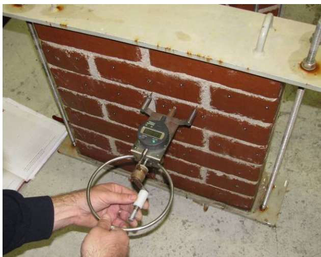
Slika 4.38: Izvedba »scratch« testa na zidku M1/5 pred zmrzovanjem/tajanjem Fig. 4.38: Scratch test on wallet M1/5 before exposure to freeze/thaw cycles
