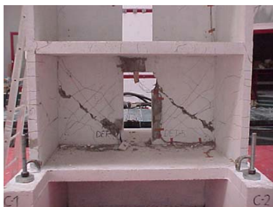
Slika 7.40: Razpoke na stojinah v prvi etaži po šesti fazi preizkusa (foto Peter Kante)
