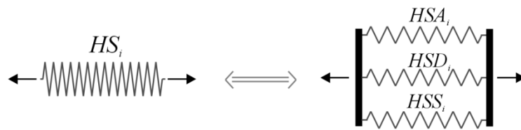
Slika 5.12: Obnašanje vzmeti HS_i lahko interpretiramo kot skupno obnašanje treh vzmeti, ki predstavljajo tri mehanizme prenosa strižnih sil prek razpok
