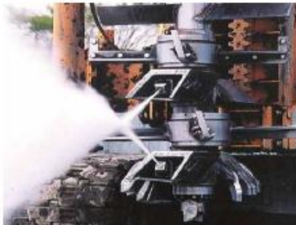
Slika 9: Mešalno orodje JACKSMAN: a) primer dvojnih rezil; b) prikaz delovanja sistema XJET (Larsson, 2003; Topolnicki, 2004)
