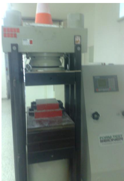
Slika 29: Naprava za določanje tlačne trdnosti [16]
