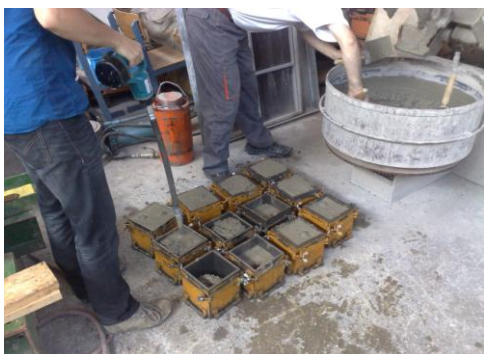
a) zgoščevanje betona
