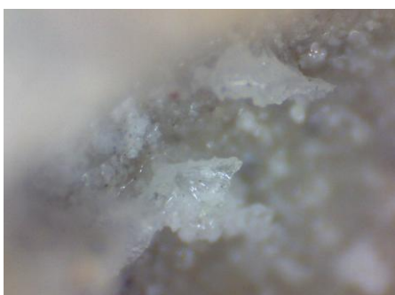
Slika 31: Kristali na površini betona preskušancev [16]
