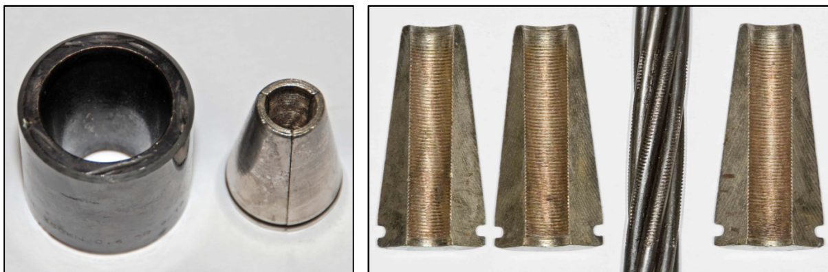
Slika F.11: Kotev in sestavljena trikraka zagozda pred preskusom (levo), detajl poškodb žic pramena (zarezni učinek) na mestih prijema zagozd (desno).
