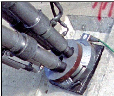
Slika 5.1: Primera iz prakse – ekscentrični legi obročastega dinamometra SISGEO med preskušanjem nosilnosti sidra.
