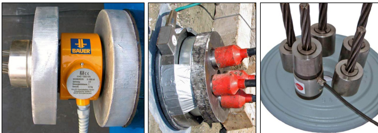
Slika E.1: Različni tipi elektronskih dinamometrov vgrajenih v prednapeta geotehnična sidra: valjasti dinamometer Bauer za sidro (levo), obročasti dinamometer SISGEO za sidro (sredina), valjasti dinamometer OG150/20 za pramen (desno).
