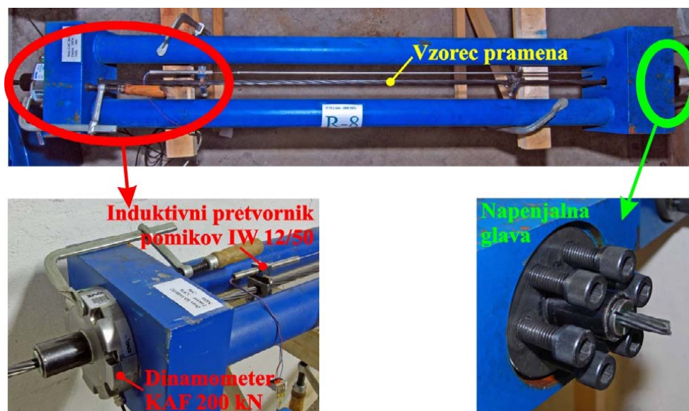
Slika 6.1: Elementi merilnega sistema za izvedbo preskušanj izotermne relaksacije po postopku izvedbe preiskav prednapetih geotehničnih sider.
