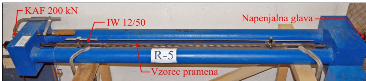
Slika F.7: Elementi merilnega sistema za izvedbo preskušanj izotermne relaksacije po postopku izvedbe preiskav prednapetih geotehničnih sider.
