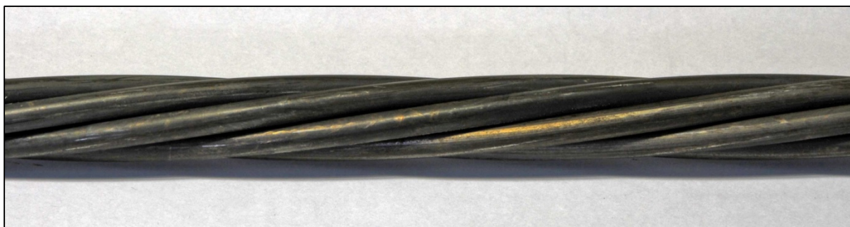
Slika 2.6: Detajl jeklenega pramena z nizko relaksacijo \varnothing 15,2 mm.
