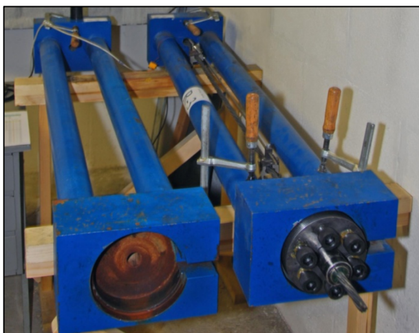
Slika F.3: Togi jekleni okvir za preskus izotermne relaksacije (leva stran fotografije); vzorec jeklenega pramena med preskusom (desna stran fotografije).
