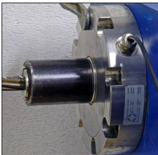
Slika F.5: Dinamometer KAF 200 kN nameščen na vzorec pramena v jeklenem preskuševalnem okviru. Figure F.5: A strand sample instrumented with a load cell KAF 200 kN installed into the steel testing frame.
