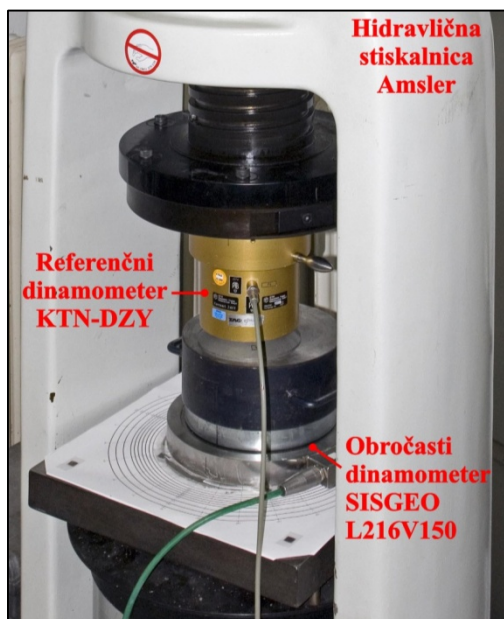
Slika 5.2: Obročasti dinamometer SISGEO L216V150 in referenčni dinamometer KTN-DZY v hidravlični stiskalnici Amsler med preskušanjem vpliva ekscentrične lege na velikost izmerjenih sil. Figure 5.2: Ring load cell SISGEO L216V150 and reference load cell KTN-DZY in the hydraulic press Amsler during the testing of influence of eccentrical positions on measured forces.
