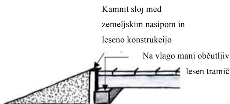
Slika 4.2 Primer ločitve lesene konstrukcije od temeljnih tal
