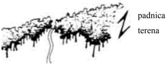
Slika 3.15 Pot z blagim vzdolžnim naklonom je odporna proti erozijskim procesom
