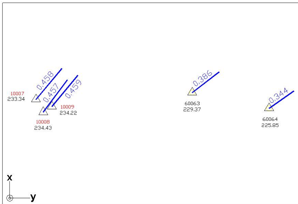
Slika 35: Prikaz horizontalnih odstopanj točk - RTK metoda izmere, območje Kubed
