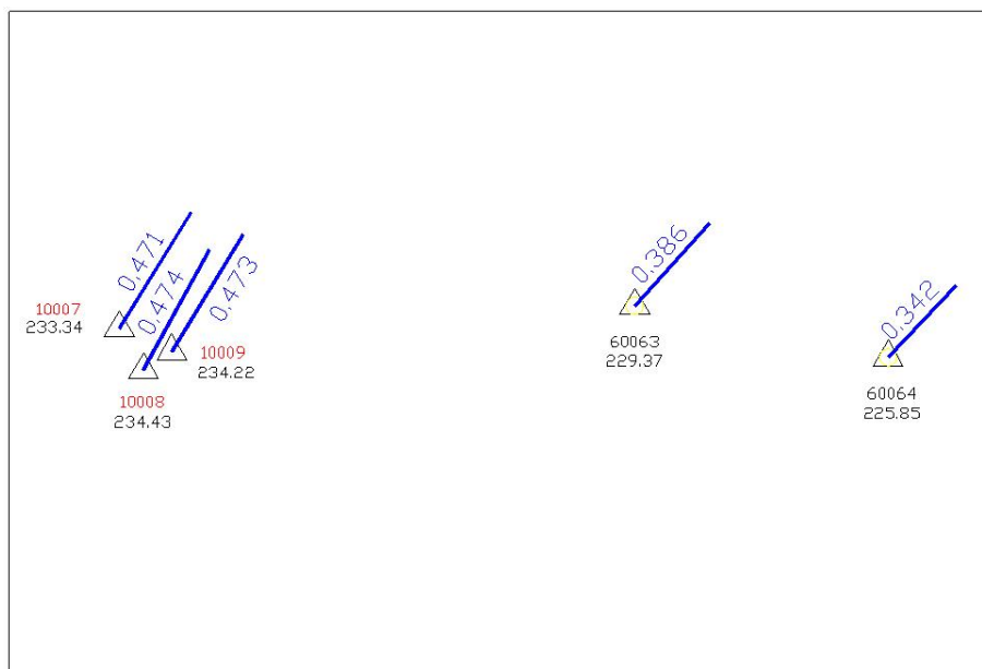
Slika 33: Prikaz horizontalnih odstopanj točk - hitra statična metoda izmere, območje Kubed
